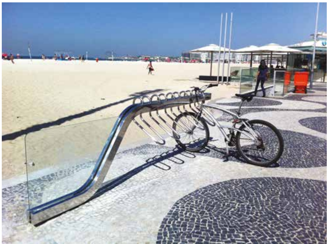
Figura 29 - Novo bicicletário da cidade do Rio de Janeiro. Projeto desenvolvido pelo escritório Índio da Costa A.U.D.T. em parceria com a Mude Mobiliários Urbanos. Estrutura em aço inox 304 e vidro temperado. Fonte: elaboração própria.
