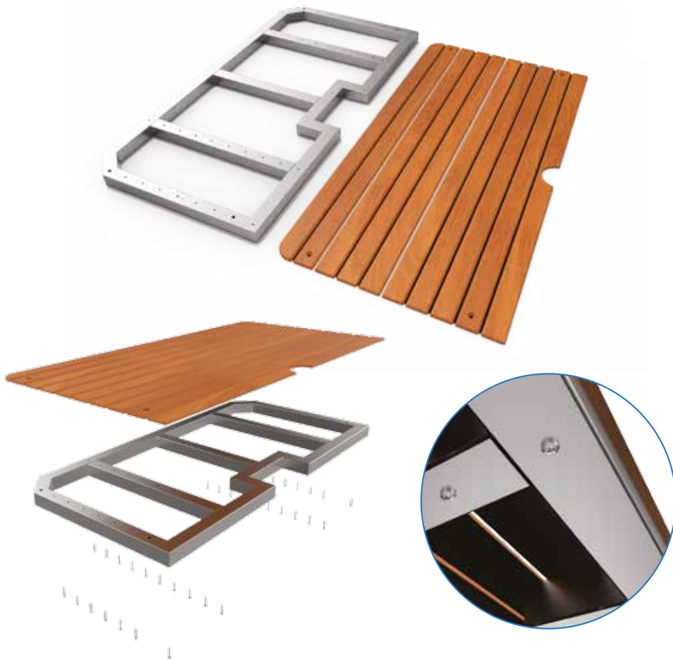
Figura 79 - Tubos e tábuas separadas. Vista explodida da base. Fonte: Elaboração própria.
