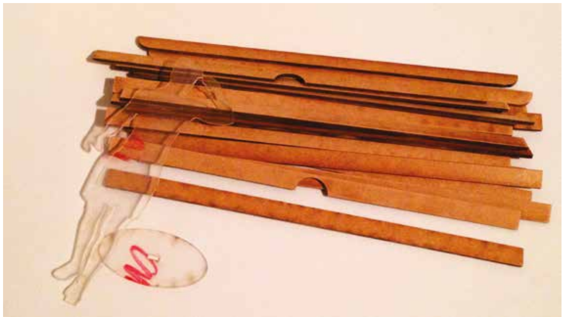
Figura 161 - Tábuas de MDF e manequim em acrílico cortados a laser, escala 1:10. Fonte: Elaboração própria.
