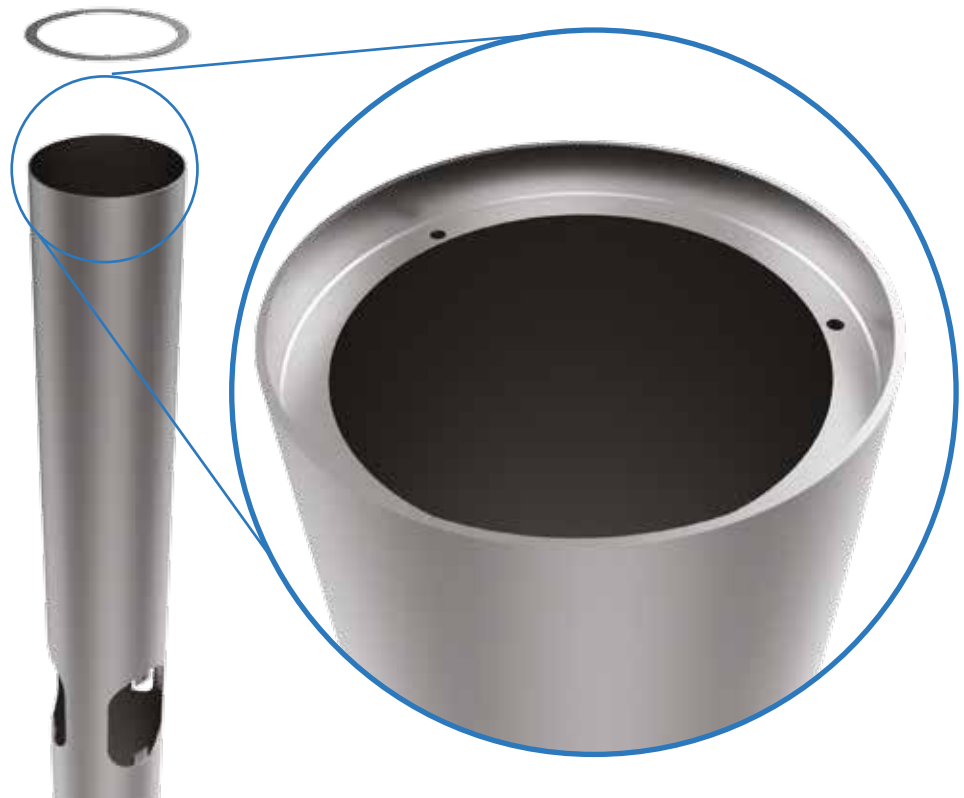
Figura 94 -Soldagem do anel na parte superior do tubo. Fonte: Elaboração própria.
