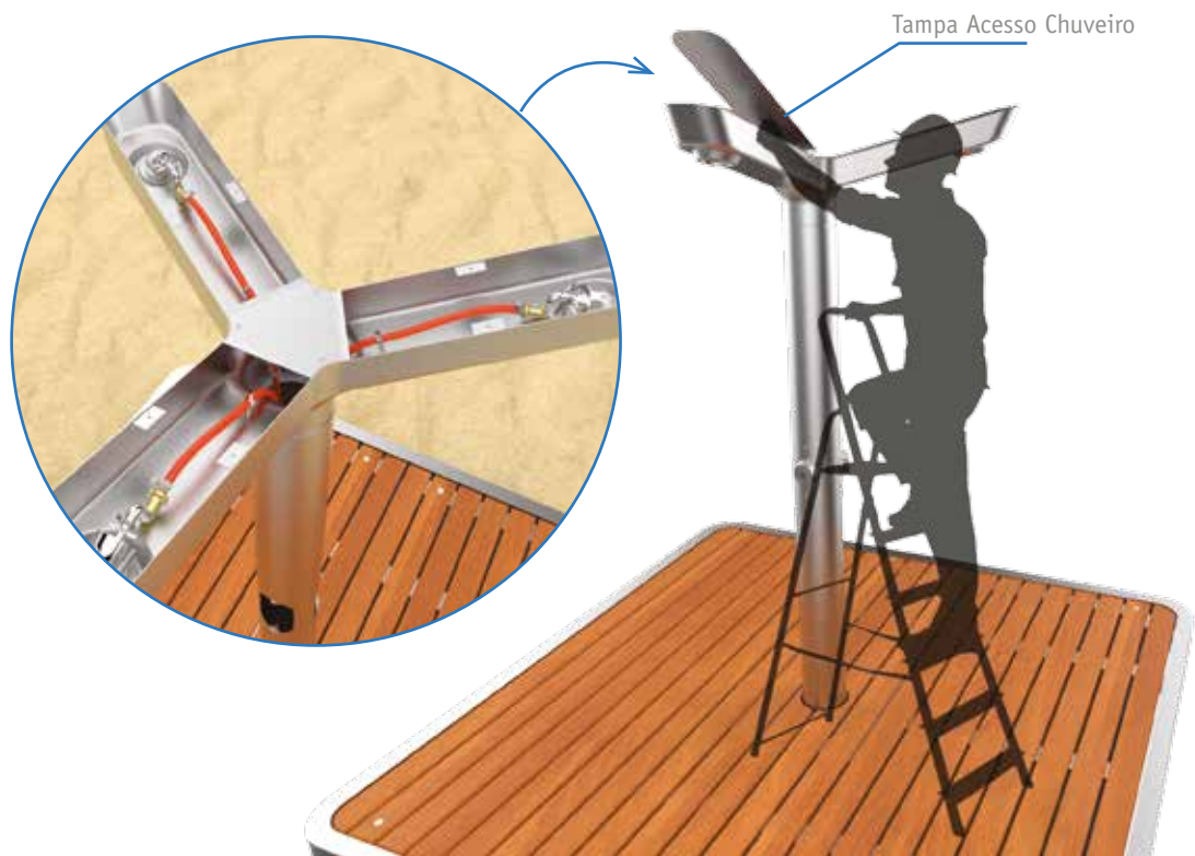
Figura 119 - Manutenção no Topo. Fonte: Elaboração própria.
