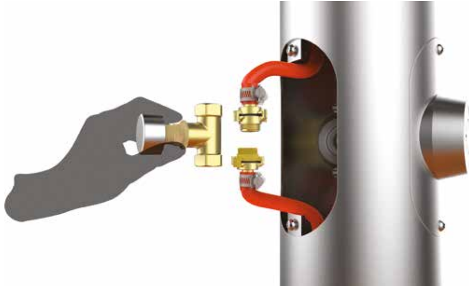
Figura 129 - Remoção completa da válvula. Fonte: Elaboração própria.
