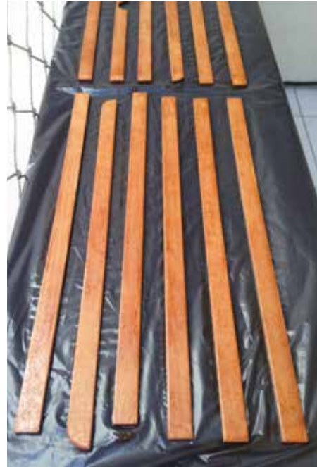
Figura 163 - Acabamento em verniz Mogno brilhante nas tábuas de MDF. Fonte: Elaboração própria.
