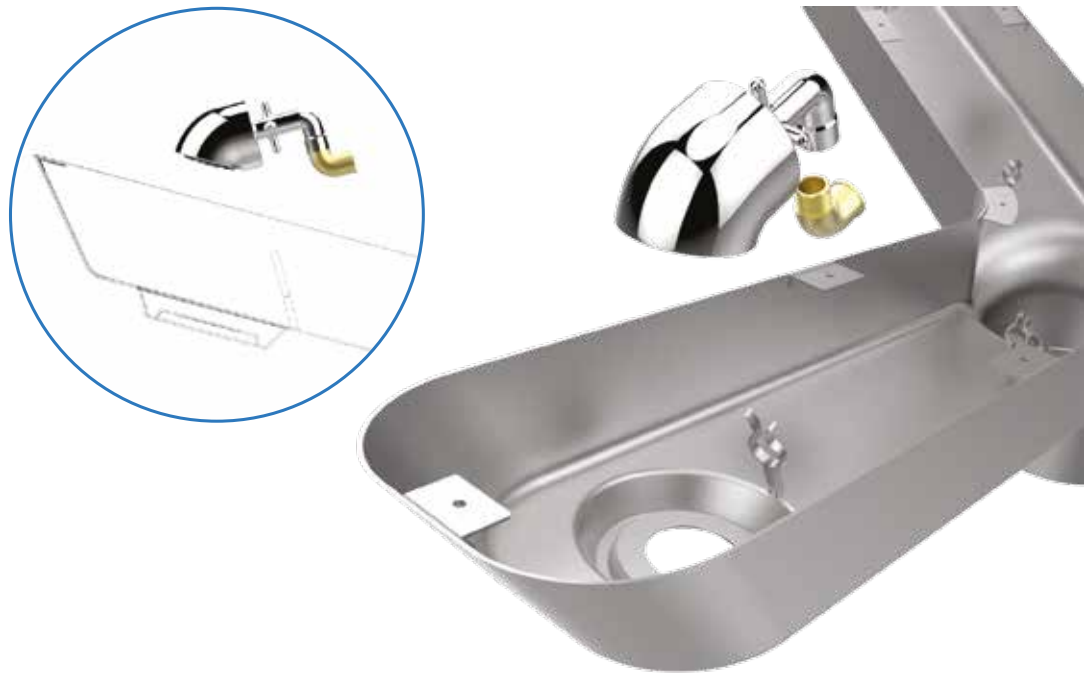
Figura 90 -Topo, chuveiro Biopress Fabrimar e joelho macho fêmea. Vista explodida. Fonte: Elaboração própria.
