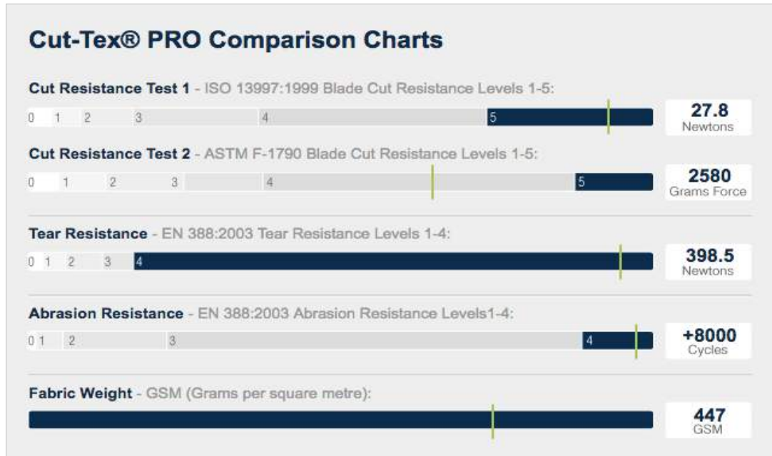
Figura 122 - Níveis de resistência do CUT-TEX® PRO de acordo com padrões das normas internacionais EN 388:203, ISO 13997:1999 e ASTM F1790
