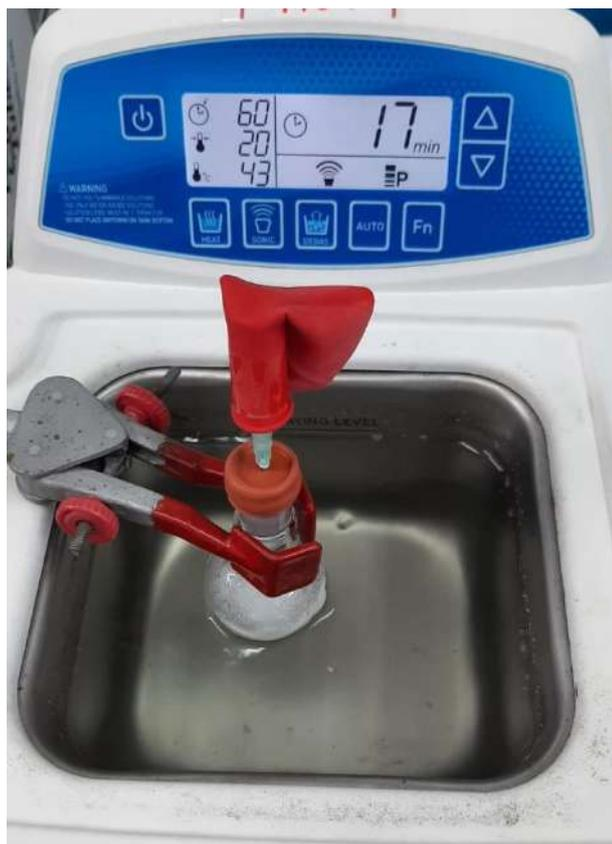
**Figura 7.** Sistema do balão no banho ultrassônico
