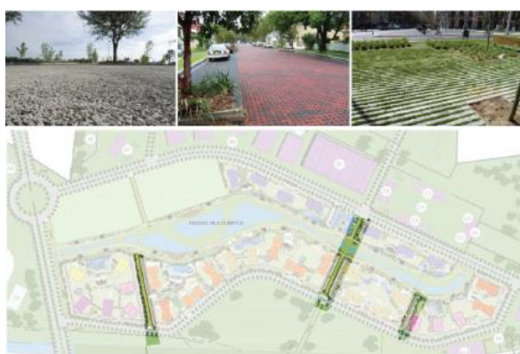
Figura 32 – Drenagem de corredor (Fonte: RELATÓRIO ILHA PURA, 2013)
