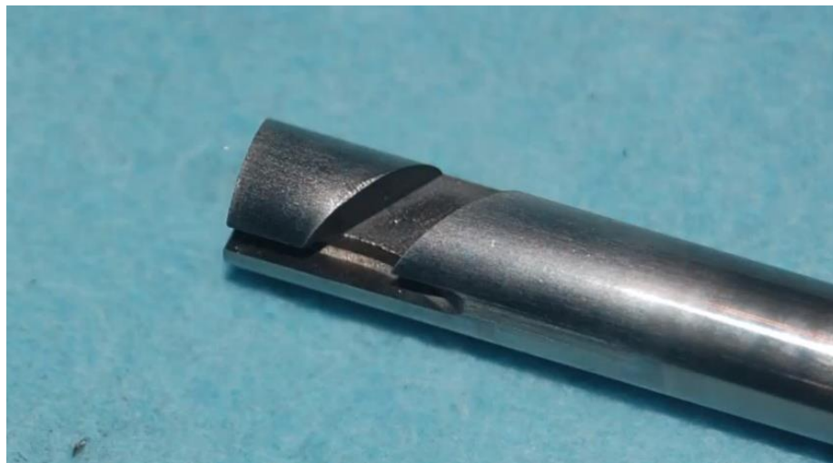
Figura 3.8 – Hélice Usinada do Pistão da Bomba em Linha [28]
