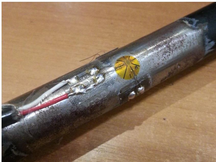
Figura 3-14: Extensômetro colado no tubo
