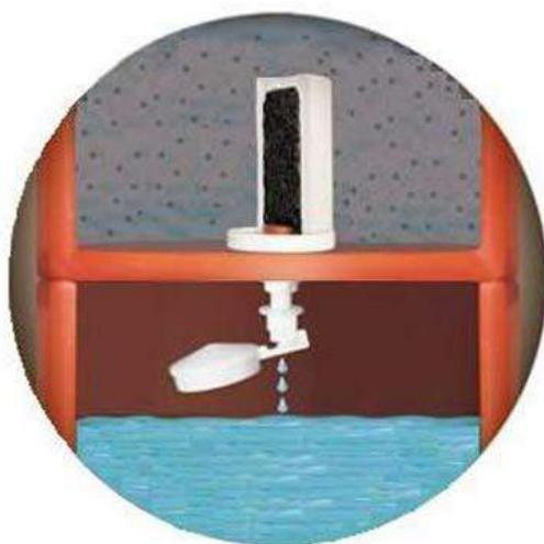
**Figura 23:** Exemplo de funcionamento de filtração pela vela (Fonte: <http://info.opersan.com.br/as-vantagens-do-filtro-de-barro>)
