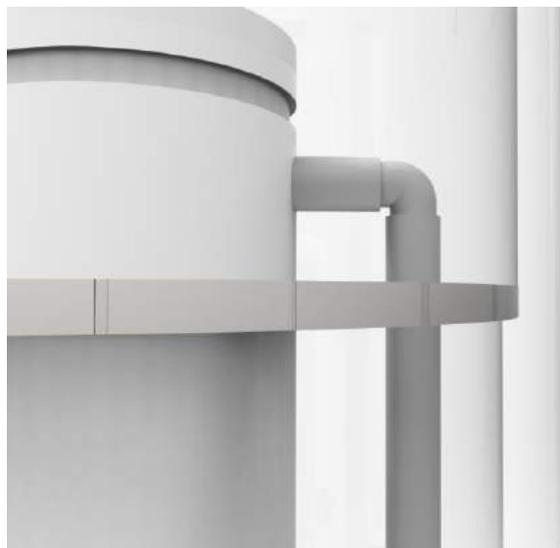
**Figura 71:** Detalhe da reentrância do duto principal para sustentação do disco de sustentação do filtro (Fonte: elaboração própria)
