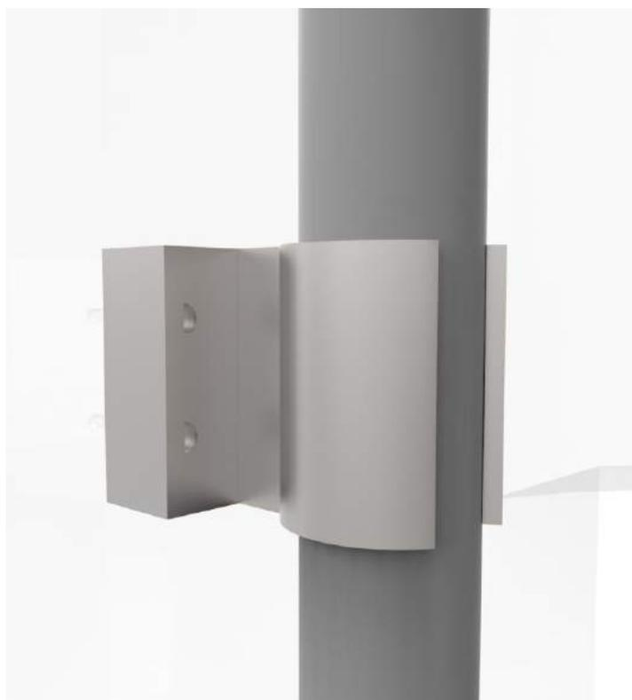
**Figura 64:** Abraçadeira aparafusada na parede do duto principal (Fonte: elaboração própria)
