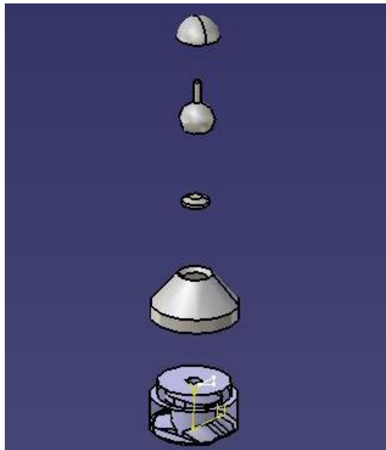
Figura 50: Perspectiva explodida do conjunto do Módulo Joystick, com base translúcida para detalhamento.
