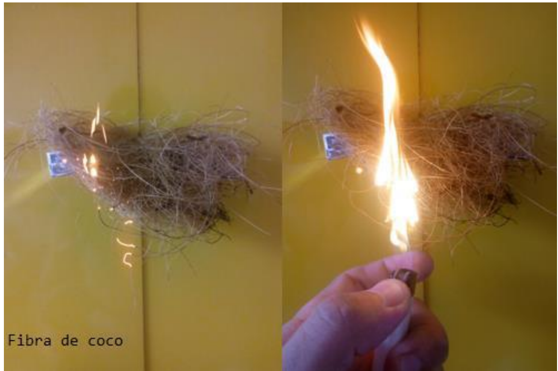
Figura 64: Teste de inflamabilidade da Fibra de Coco. Classificação: Alto. Elaboração própria.
