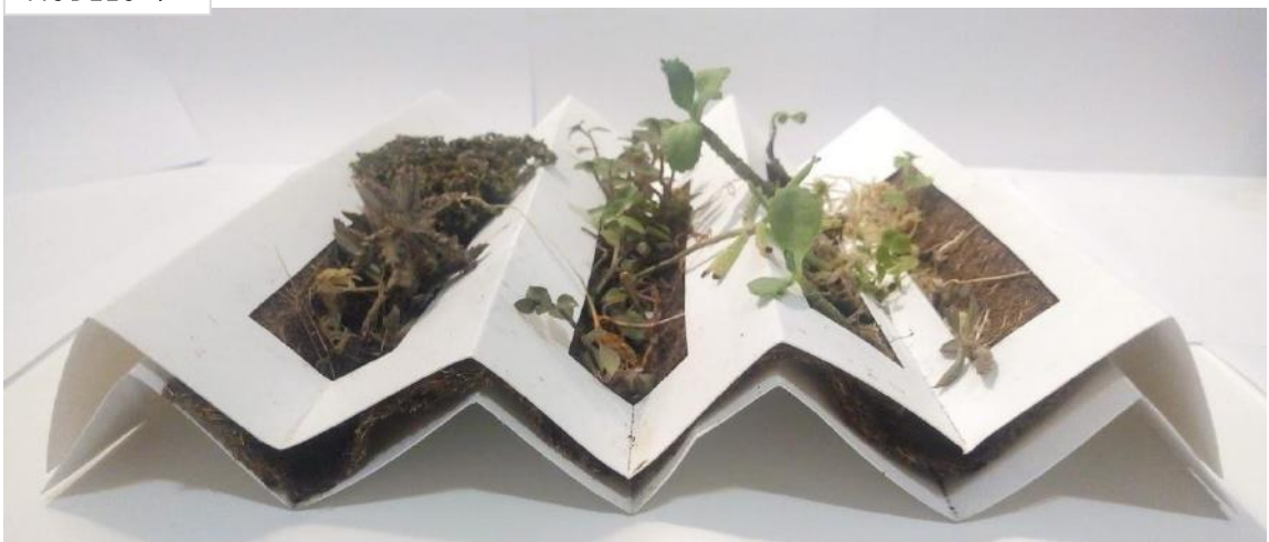
Figura 101: Vistas do modelo 4, utilizando duas chapas de polipropileno e substrato Coquim. Elaboração própria.
