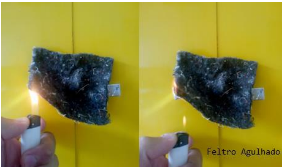
Figura 63: Teste de inflamabilidade do Feltro Agulhado. Classificação: Alta. Elaboração própria.
