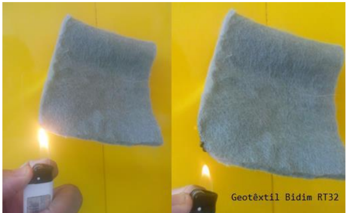
Figura 65: Teste de inflamabilidade do Bidim RT32. Classificação: Baixo. Elaboração própria.
