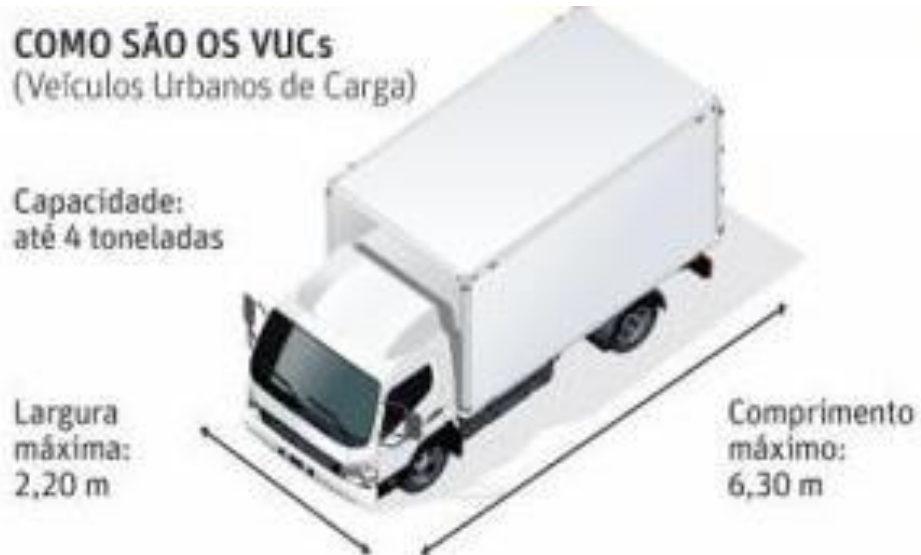
Figura 126: Dimensões dos VUC. Fonte: http://rntrc-antt.com.br/noticias/9087 (Acessado em 30/11/2018).
