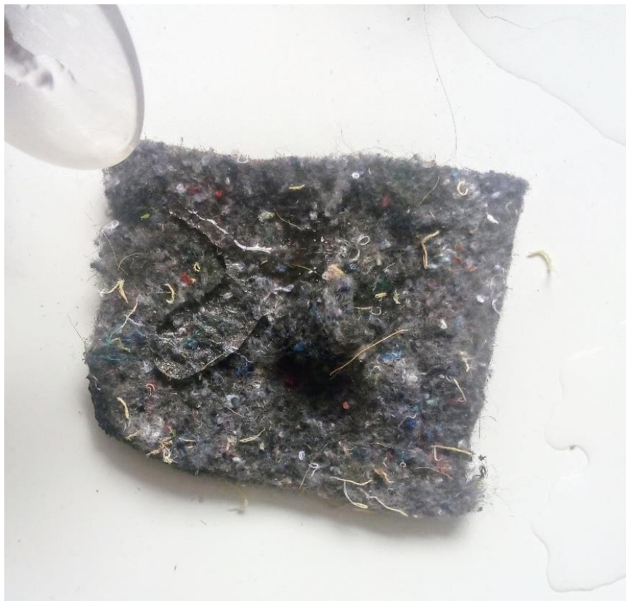
Figura 72: Teste de higroscopia do Feltro agulhado. Classificação: Média. Elaboração própria.
