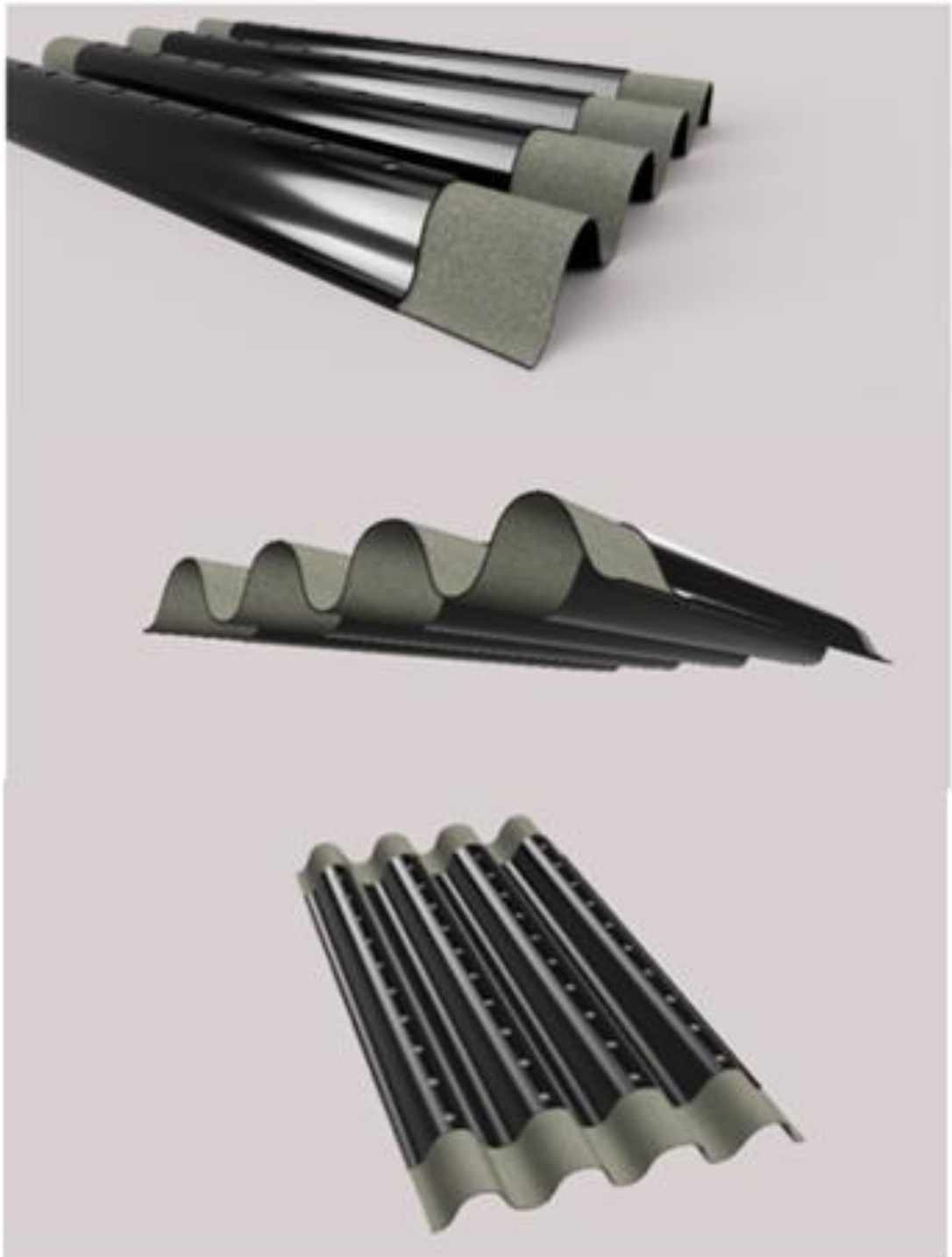
Figura 84: Modelo simulando o sanduíche de telhas poliméricas com substrato geotêxtil Bidim. Elaboração própria.
