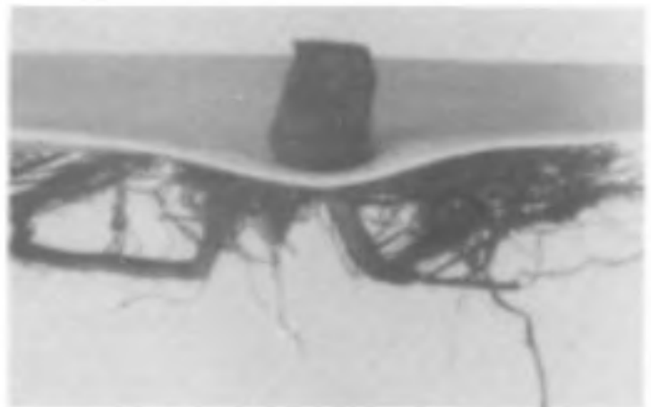
4.6 Perforación en una unión pegada de dos láminas de PVC producida por una raíz (Pennigfeld et al. 1981)
