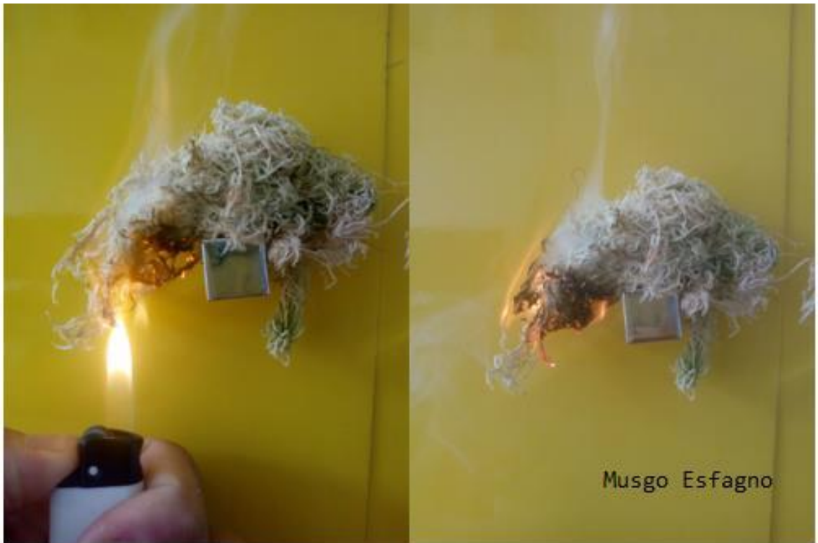
Figura 610: Teste de inflamabilidade do Musgo Esfagno. Classificação: Médio. Elaboração própria.
