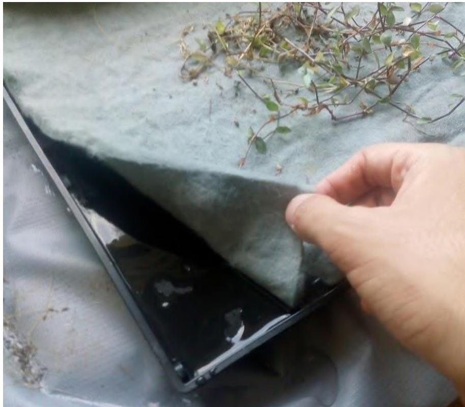
Figura 135: Experimento feito com bandeja de polipropileno com 15mm de altura para observar a retenção de água do compartimento. Elaboração própria.
