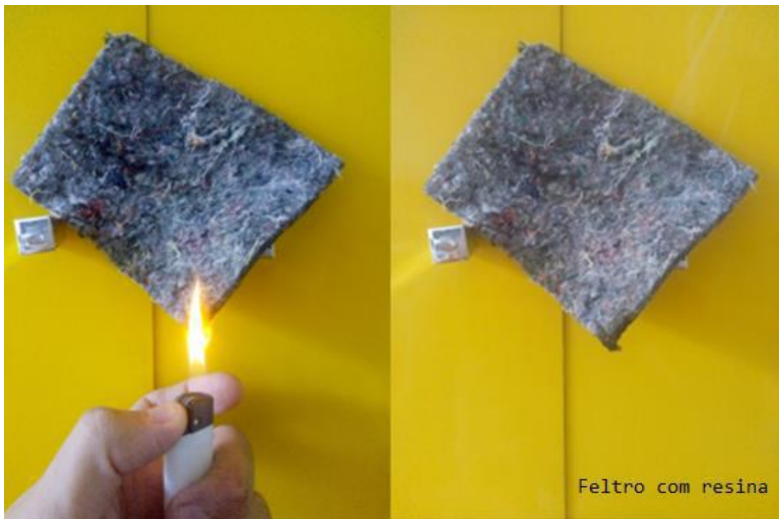
Figura 59: Sequência das etapas do teste de inflamabilidade. Nota -se que o feltro com resina derreteu e a chama se apagou após alguns segundos. Classificação: Baixo. Elaboração própria.
