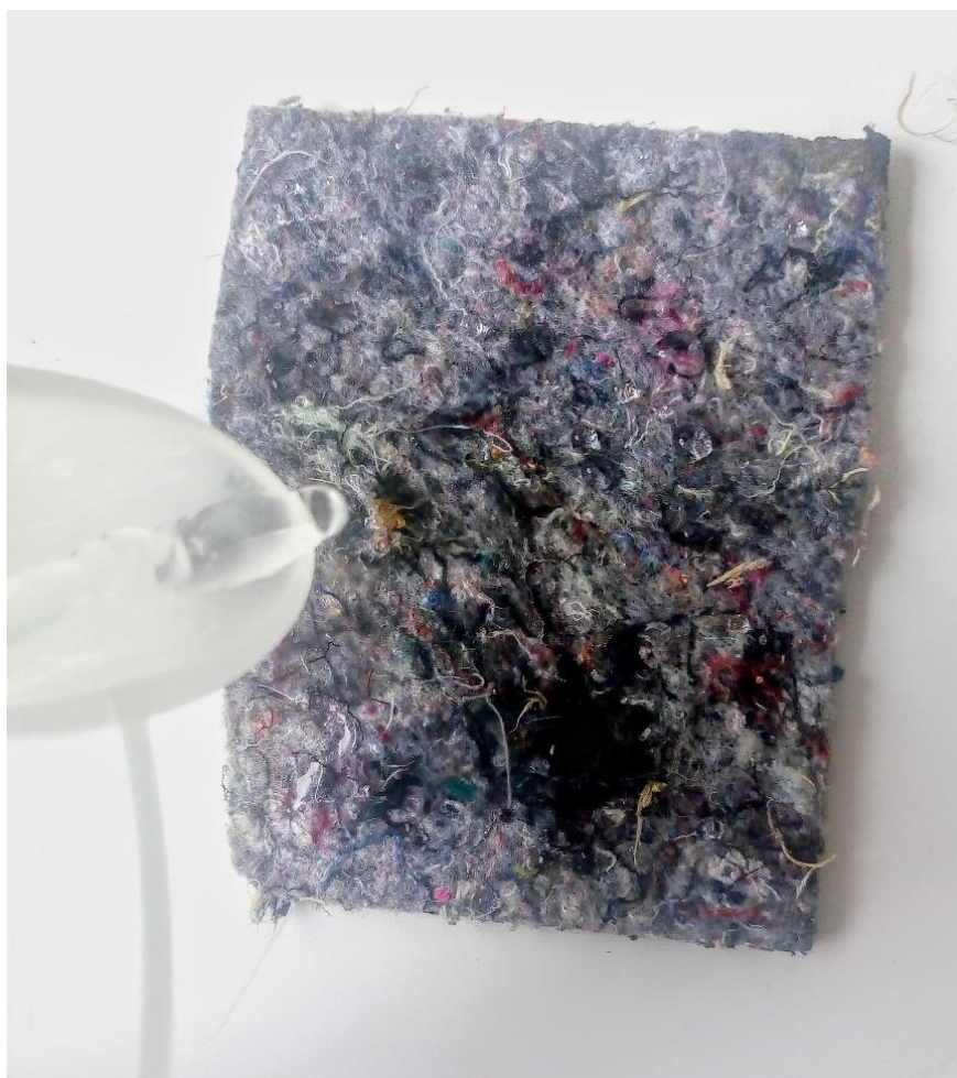
Figura 67: Teste de higroscopia do Feltro com resina. Classificação: Baixa. Elaboração própria.
