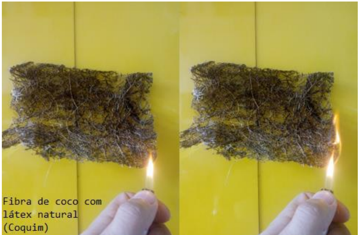
Figura 62: Teste de inflamabilidade do Coquim. Classificação: Baixa (Material demorou a pegar fogo e a chama não se espalhou pelo corpo de prova. Elaboração própria.
