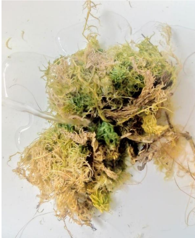
Figura 68: Teste de higroscopia do Musgo esfagno. Classificação: Alta. Elaboração própria.
