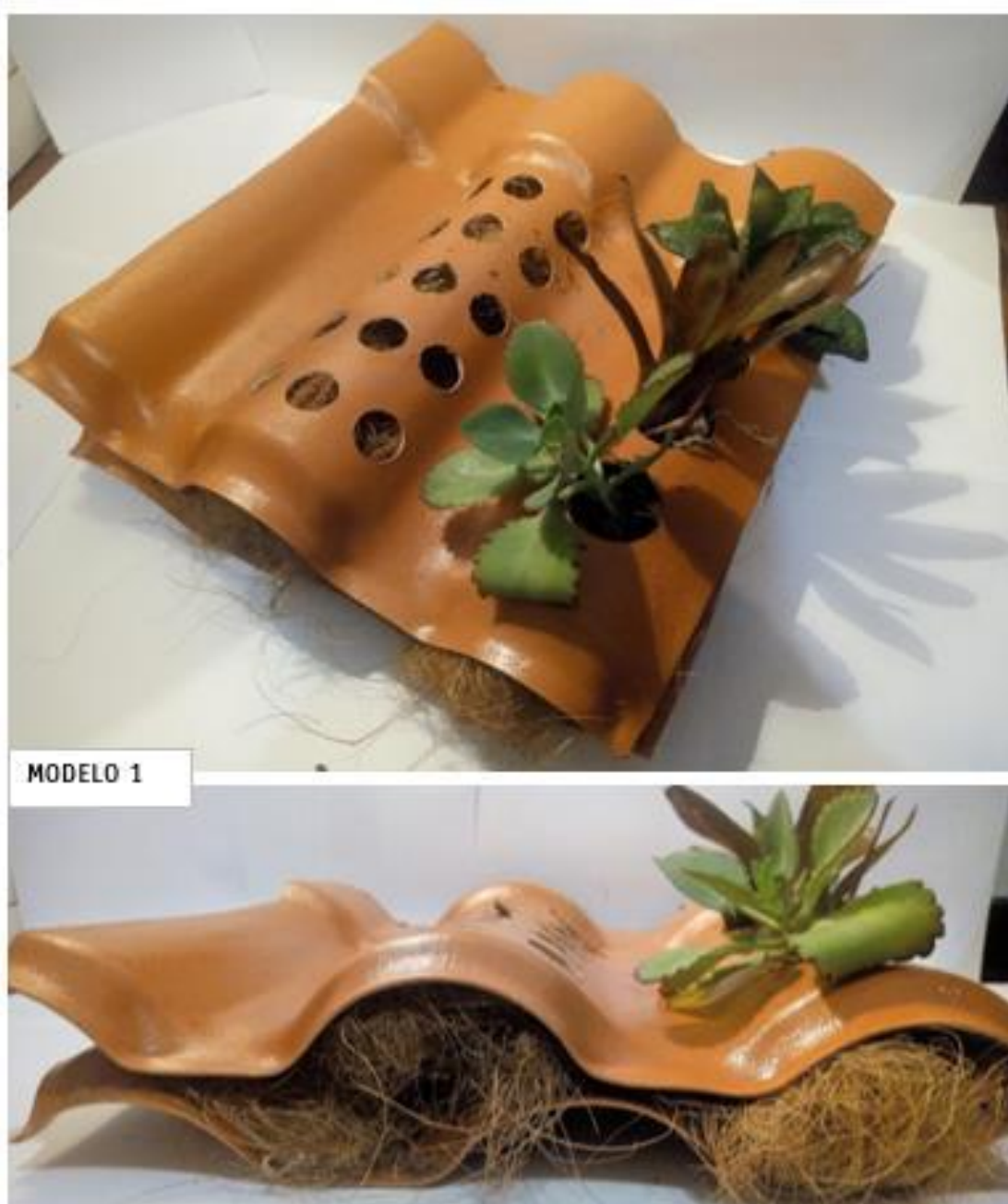
Figura 88: Primeira versão do modelo 1, com furos nas montanhas e substrato de fibra de coco. Elaboração própria.
