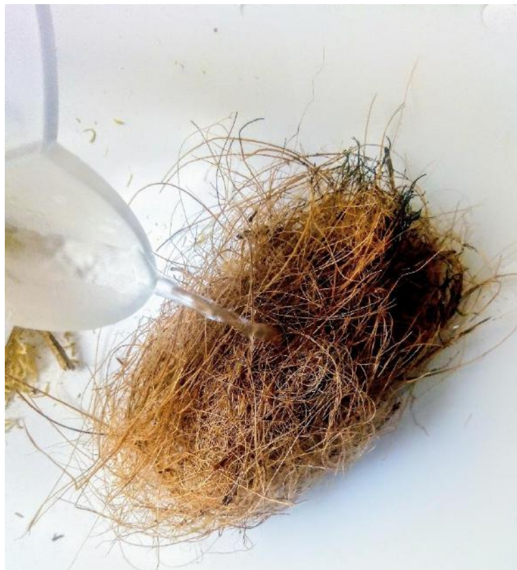
Figura 7069: Teste de higroscopia da Fibra de coco. Classificação: Baixa. Elaboração própria.
