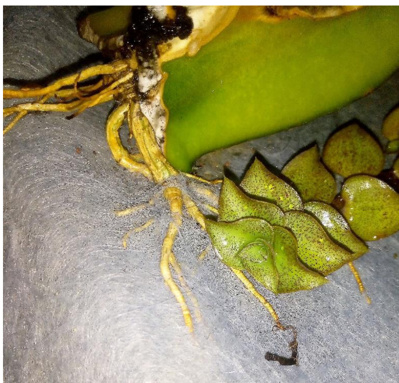
Figura 50: Detalhe do enraizamento da vegetação entre as fibras de poliéster do Bidim RT 16. Elaboração própria.
