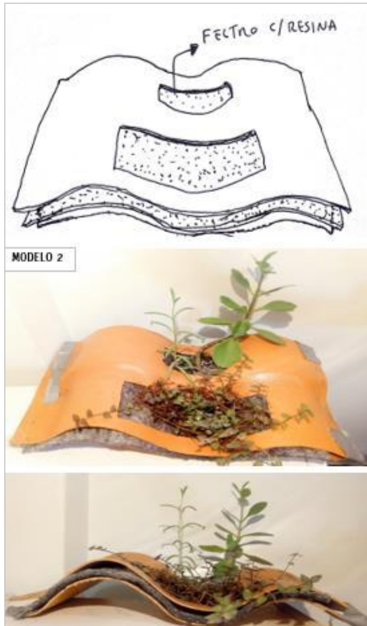
Figura 92: Representação do modelo 2 utilizando feltro com resina como substrato. Elaboração própria.
