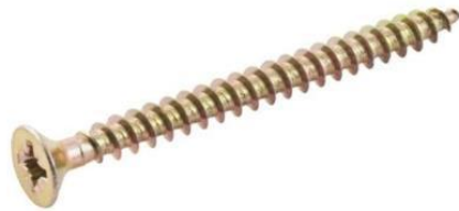
Figura 118: Parafuso para madeira de cabeça chata tipo Philips de 6 x 30mm, fabricados em aço carbono bicromatizado amarelo. Retirado do site da fabricante Vonder.
