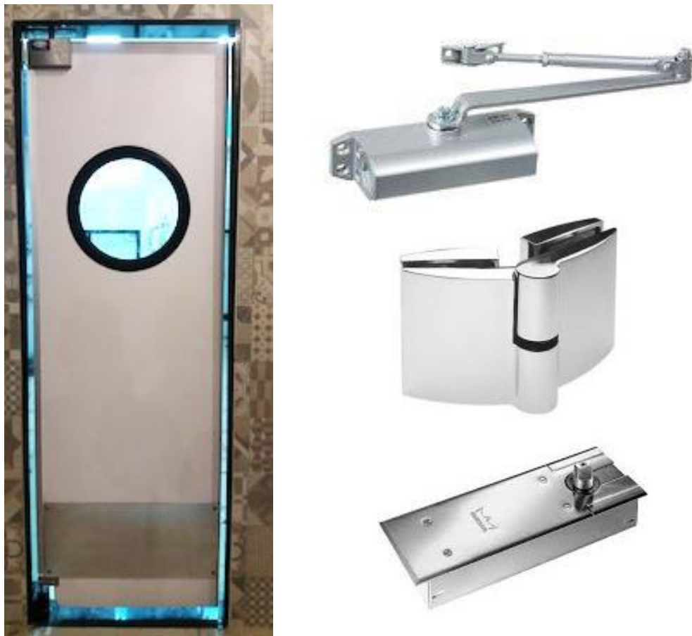
Figura 37: Porta de cozinha com mola instalada (canto superior esquerdo), e três mecanismos de fechamento automático de portas diferentes: de cima para baixo, braço articulado, dobradiça e pivô.
