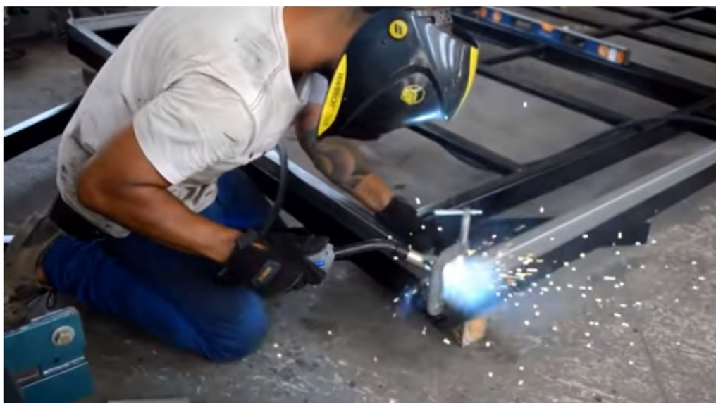
Figura 60: Solda de perfis de alumínio para produção de estrutura Fonte: escuber.com.br
