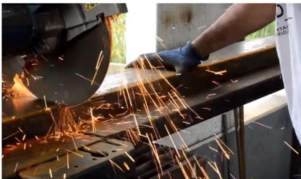
Figura 59: Corte de perfil de alumínio com serra para produção de chassi Fonte: escuber.com.br
