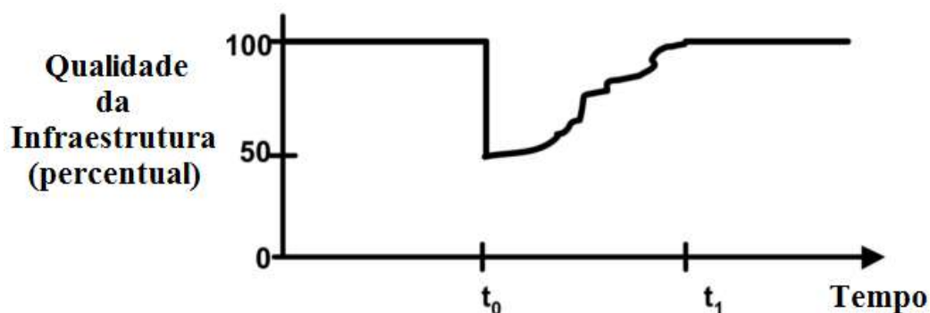
Figura 2: Qualidade da Infraestrutura em função do tempo, dado um evento. Fonte: Bruneau et al., 2003
