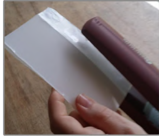
Figura 44: Chapas de PP sendo unidas por calor. Fonte: Arquivo pessoal, 2014.
