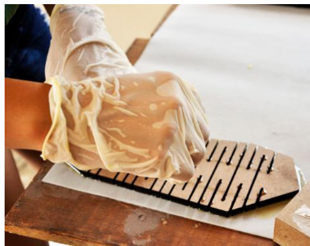
Figura 89 Removendo excessos com espátula (Acervo das autoras)
