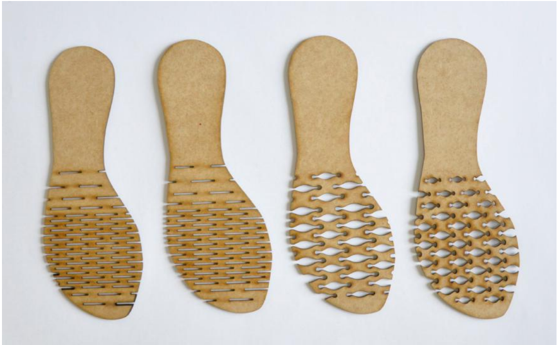
Figura 72 Padrões de corte aplicados e cortados a laser em MDF de 3mm (Acervo das autoras)
