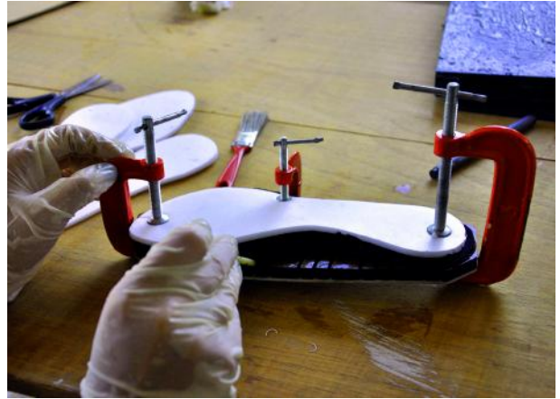
Figura 91 Colando todas as partes com o auxílio de sargentos (Acervo das autoras)
