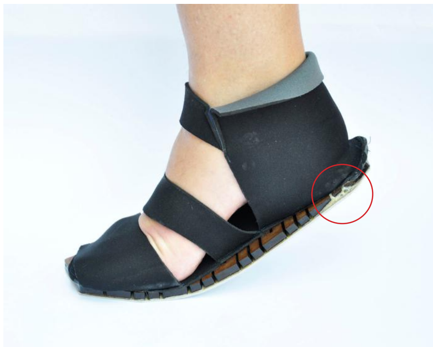
Figura 94 Peça piloto com cabedal manchado de resina em teste de usabilidade (Acervo das autoras)
