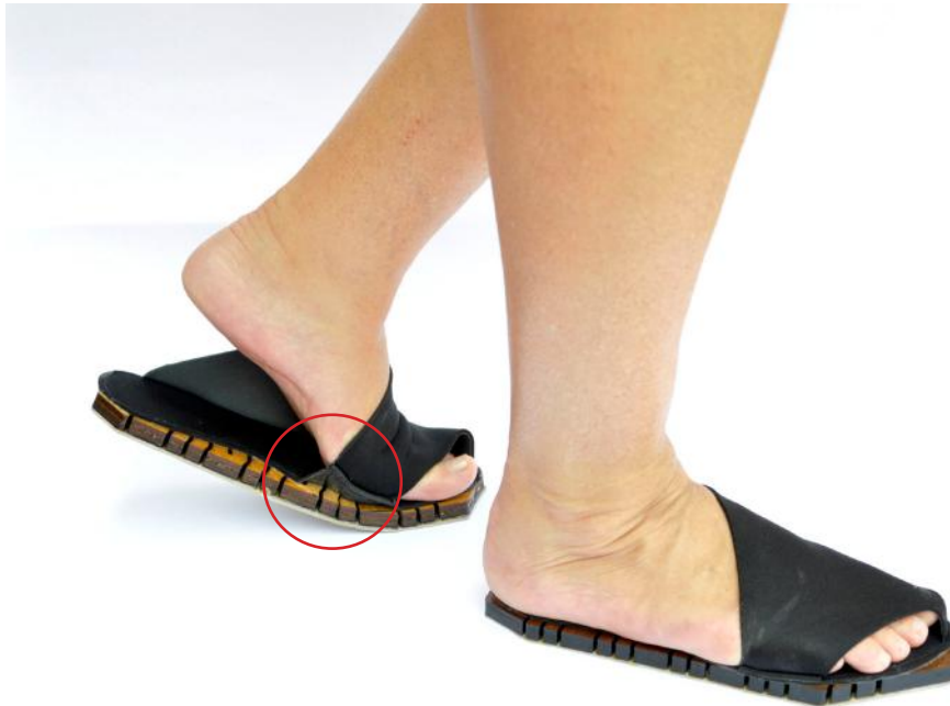
Figura 93 Peça piloto que descolou em teste de usabilidade (Acervo das autoras)
