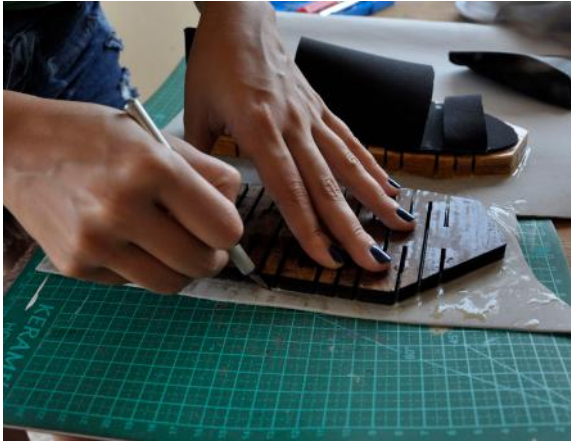
Figura 90 Corte do E.V.A excedente (Acervo das autoras)
