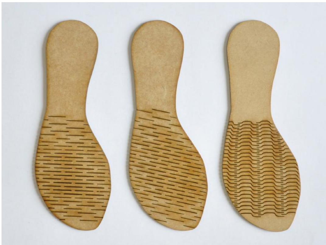
Figura 73 Padrões de corte aplicados e cortados a laser em MDF de 3mm (Acervo das autoras)
