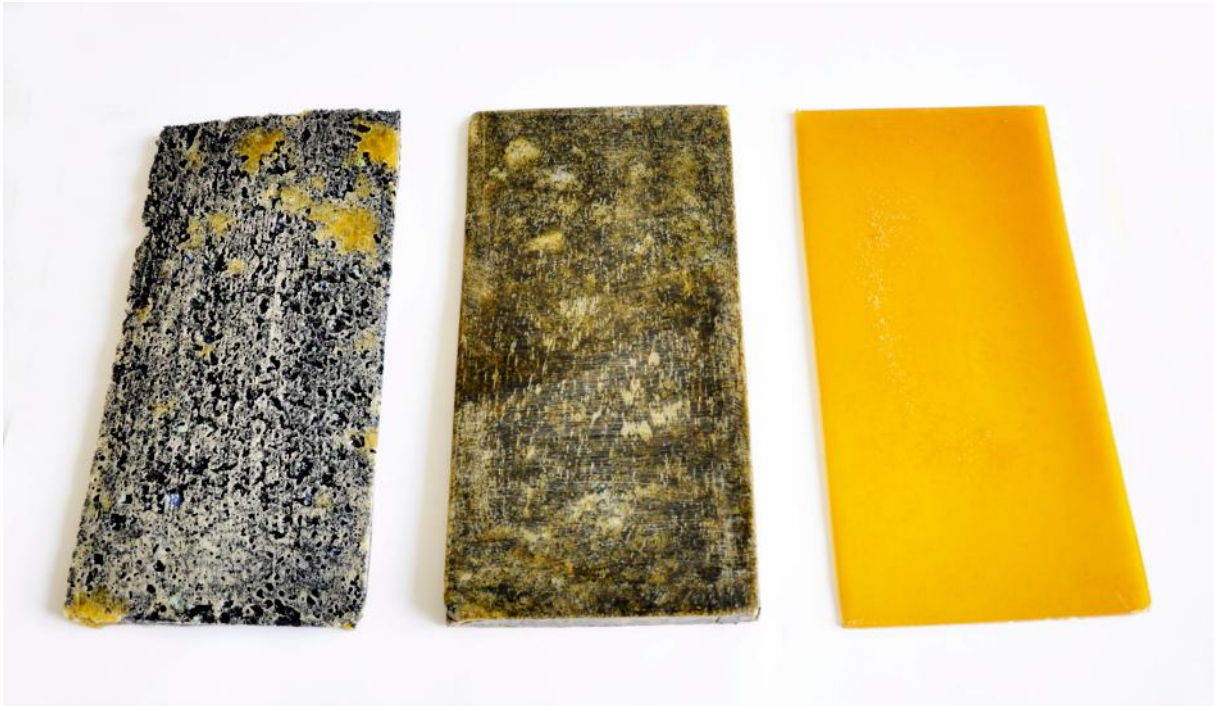
Figura 119 Testes com refugo de couro sem pressão, sob pressão e resina pura(Acervo das autoras)
