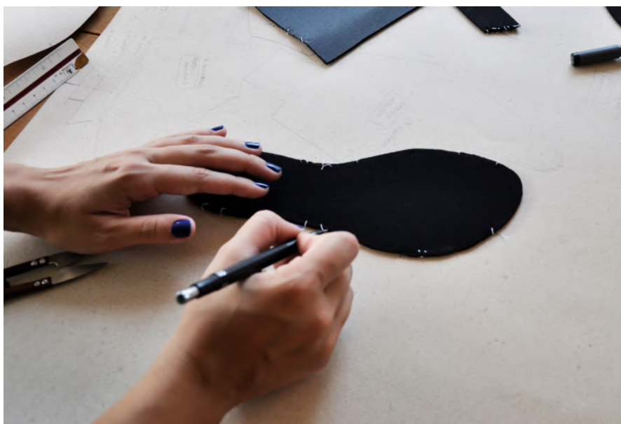
Figura 86 Confecção de molde do neoprene para o papel duplex (Acervo das
