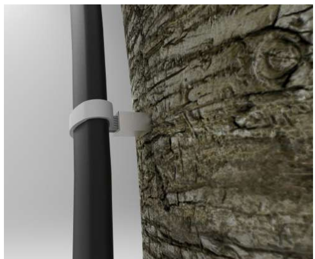
figura 143 - Render mostrando a fixação do sistema na árvore. Elaboração própria.
