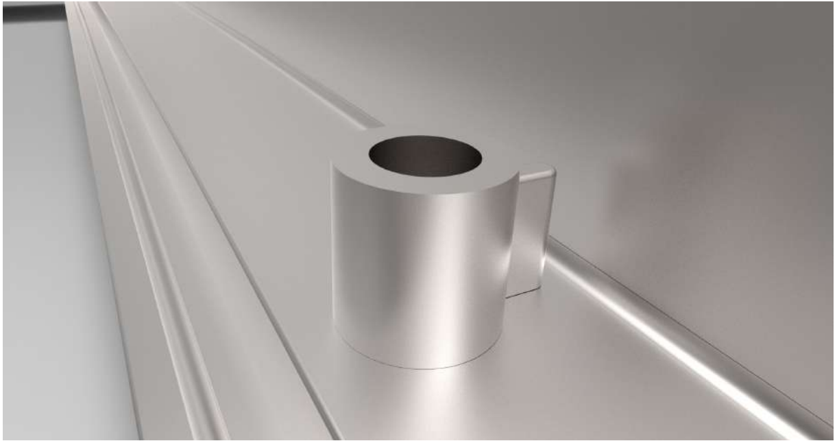
figura 124 – Render mostrando a furação do fixador do refletor e do painel. Elaboração própria.
