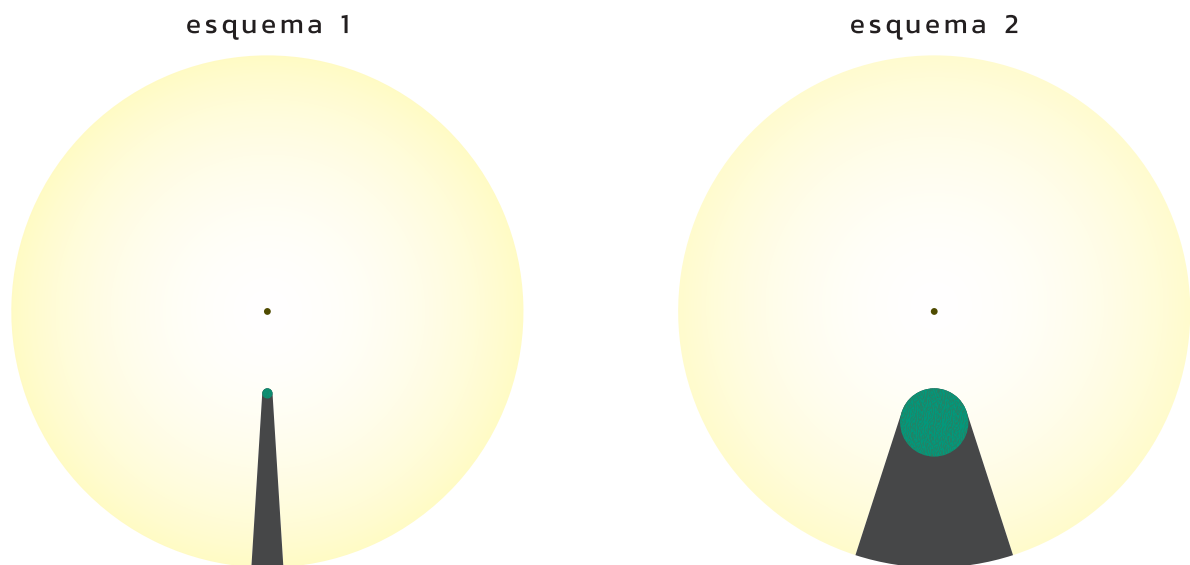
figura 38 - Esquemática sobre diâmetro do tronco e a área da sombra projetada pela fonte luminosa. Elaboração própria.
