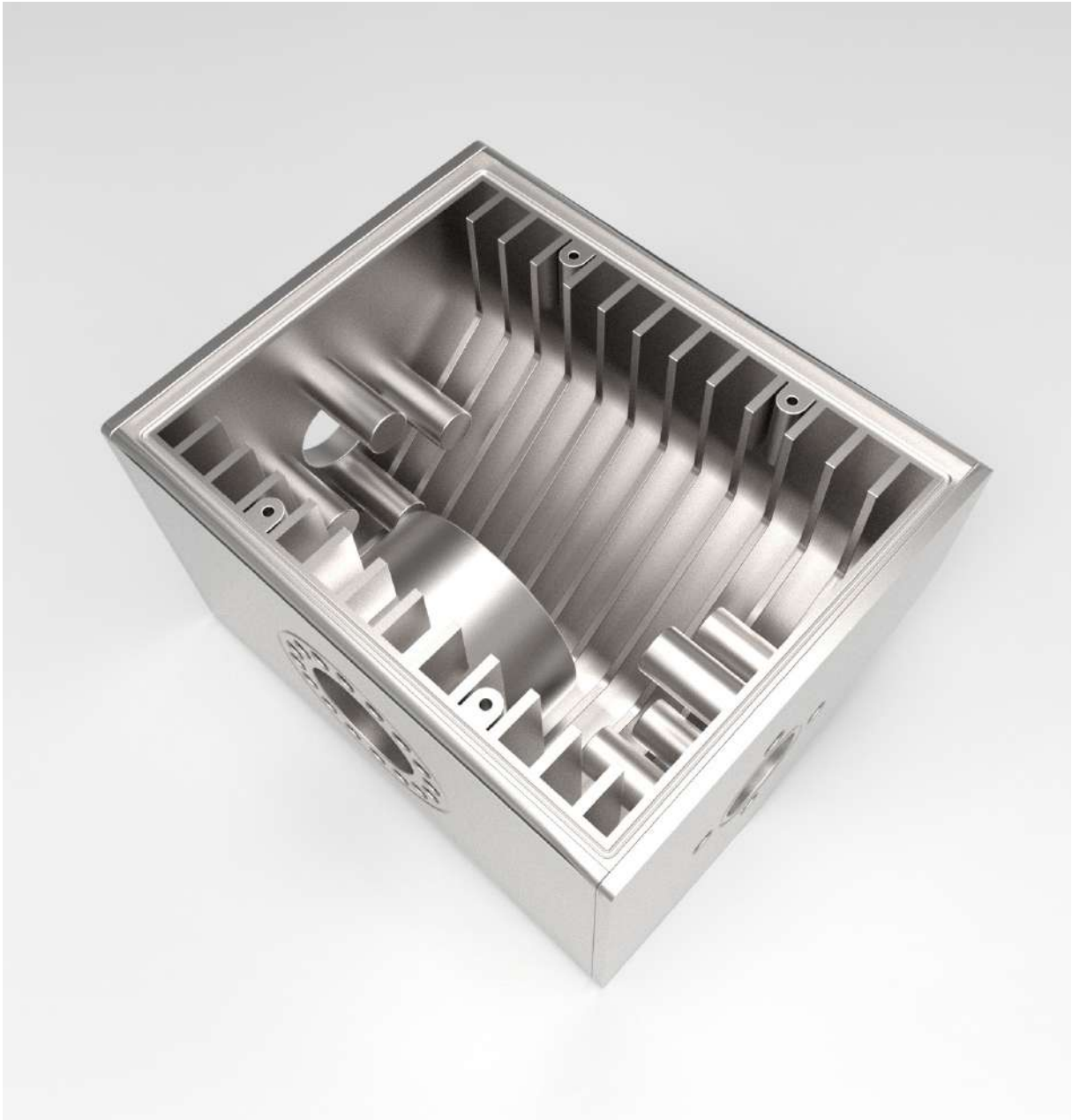
figura 119 - Render mostrando a parte interna do sistema de rotação central. Elaboração própria.
