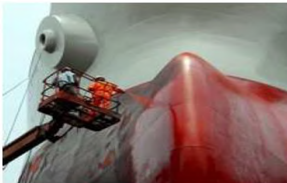
FIGURA 7. Navio com detalhes da pintura antiincrustante.
