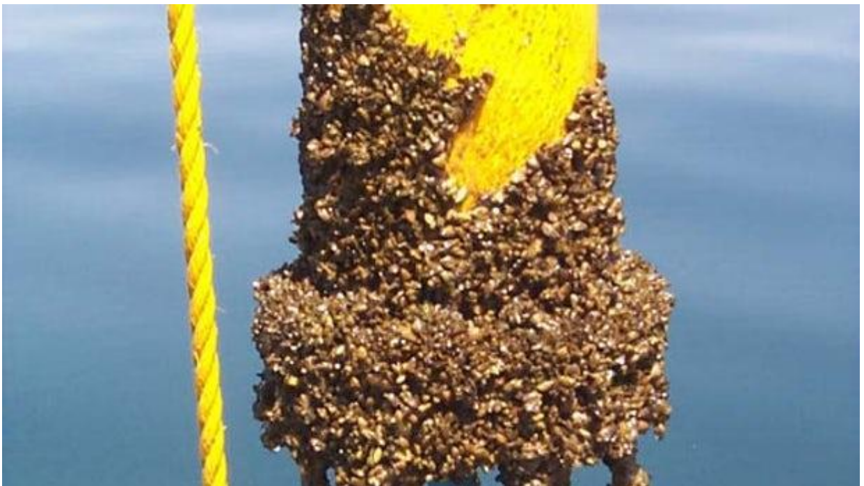
FIGURA 4. Mexilhão-zebra colonizando um sensor marinho (Adaptado de http://newatlas.com/twitch-antifouling-coating/26063/ )
