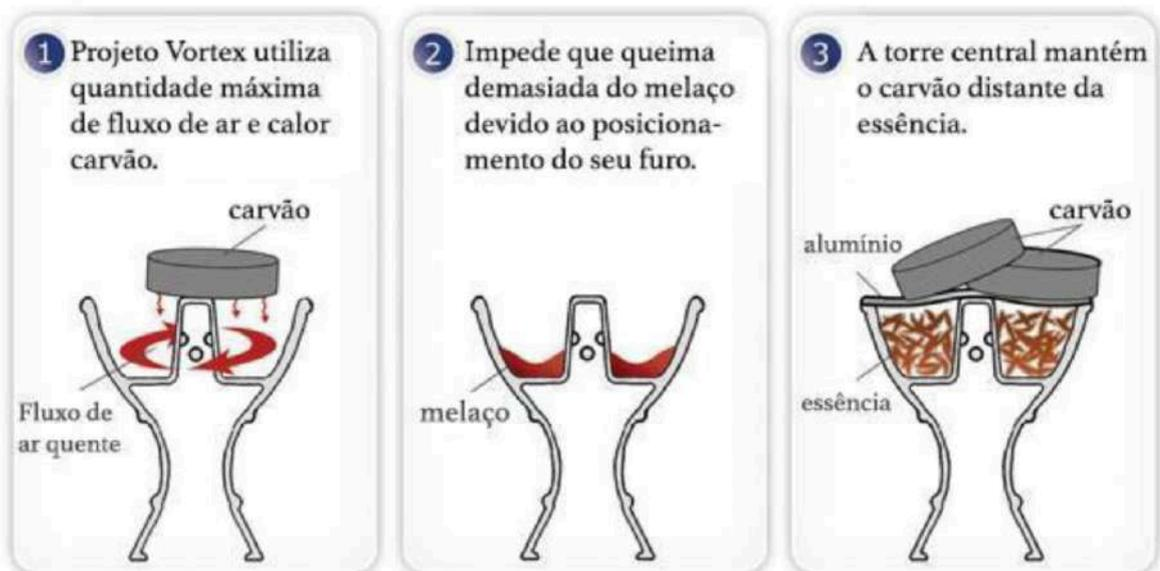
Figura 21. Transferência de calor no Rosh Vórtex.
