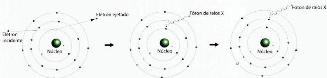
Figura 2.8 – Um elétron incidente retira um elétron orbital, deixando uma vacância. O elétron da camada mais externa ocupa essa vacância. A energia em excesso, é liberada na forma de fóton de raios X [60].
