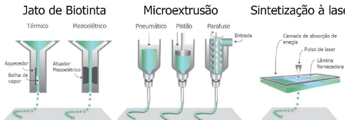
Figura 11 - Diferentes técnicas de bioimpressão 3D
