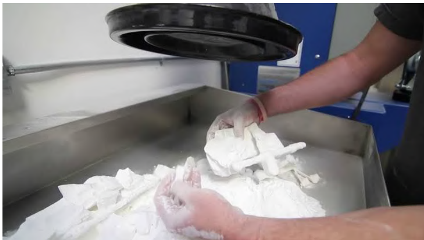
Figura 8 - Peça sendo retirada do recipiente após ser impressa utilizando a técnica SLS
