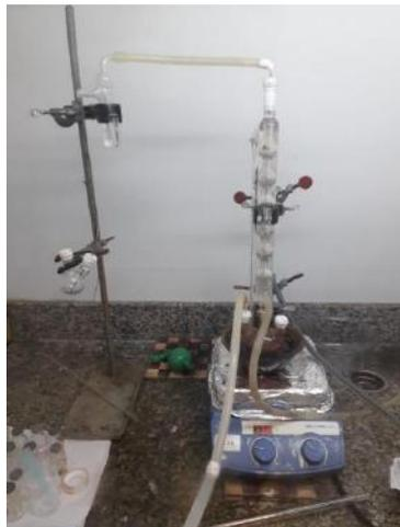
**Figura 8** – Aparato para reação de proteção do galato de metila.
