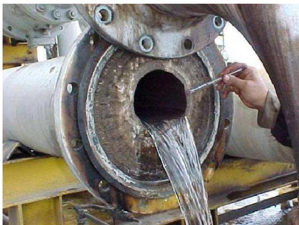
**Figura 1** – Exemplo de incrustação em tubulação de descarte de água.
