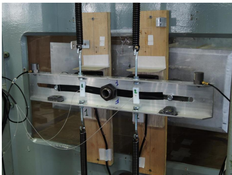
Figura 4.12 – Apoios flexíveis fixados ao modelo seccional a fim de reproduzir as propriedades dinâmicas do tabuleiro (LOREDO-SOUZA et al. , 2014).
