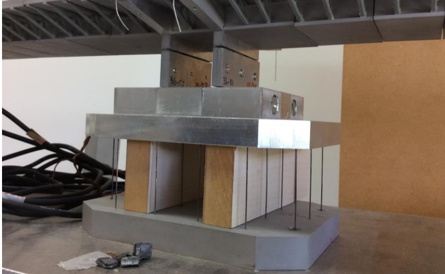
Figura 4.16 - Detalhe das fundações dos apoios com fios de aço, em mesmo número que as estacas e comprimento livre para representar a flexibilidade na interação solo-estrutura (LOREDO-SOUZA et al. , 2015).
