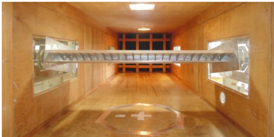
Figura 4.8 – Modelo seccional rígido no interior do túnel de vento (LOREDO-SOUZA et al. , 2014).
