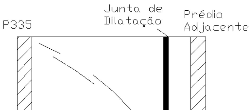
Figura 7.5: Esquema da trinca existente entre o pilar P335 e o outro prédio
