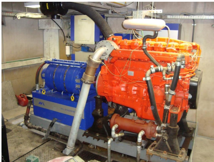
Figura 3.1 – Motor Scania DI12 59 M acoplado ao dinamômetro.
