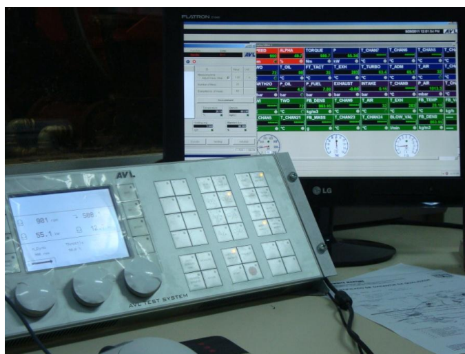
Figura 3.3 – Controle e monitoração dos parâmetros pelo software AVL PUMA OPEN.
