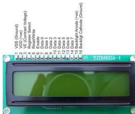
Figura 3.6 – Pinagem Display 16x2.
