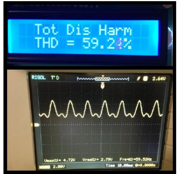
Figura 4.15 – Teste THD Valor teórico 60%.
