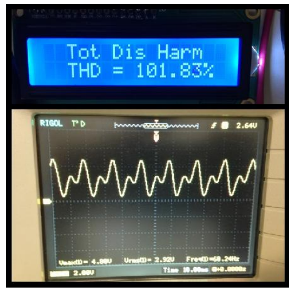
Figura 4.17 – Teste THD Valor teórico 100%.
