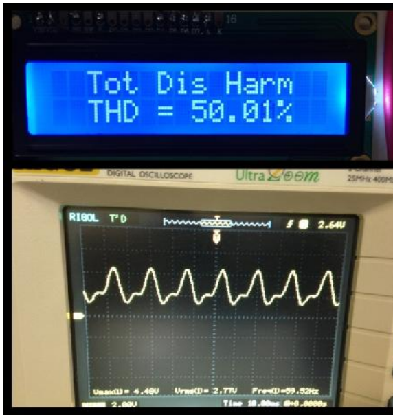
Figura 4.14 – Teste THD Valor teórico 50%.
