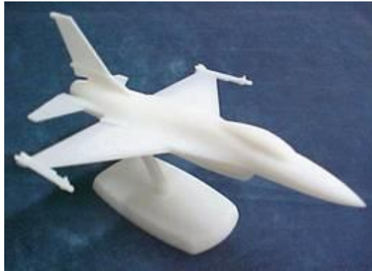
Figura 5 - Aeromodelo Construído com resina Fotocurável [8]
