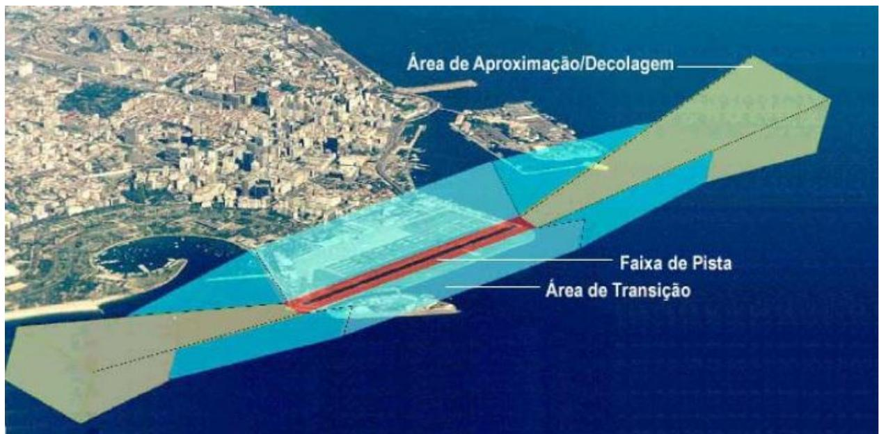
**Figura 20- Croqui de um Plano Básico de Zona de Proteção de Aeródromo (PBZPA)**
