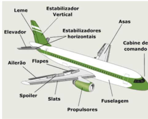
Figura 10- Esquema demonstrativo das partes da fuselagem da aeronave
