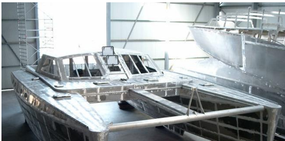
Figura 2: Construção de um Catamarã de alumínio.
