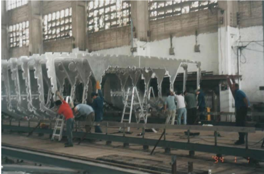
Figura 4: Método construtivo: posicionamento das cavernas.
