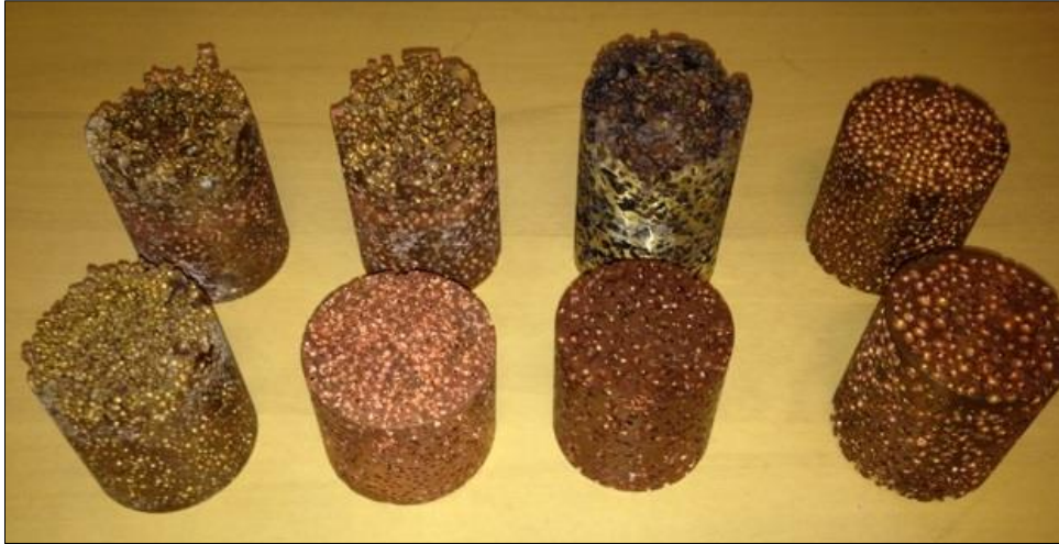
Figura 23. Espumas de latão cilíndricas de 50 mm de diâmetro conforme recebidas, ainda com espaçadores de sílica-gel em seu interior.
