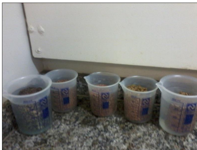
Figura 24. Espumas de cobre-zinco em banho de solução de HF para remoção dos agentes espaçadores.
