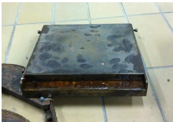
Figura 25 – Dispositivo de deslizamento da prensa que aplica a tensão vertical
