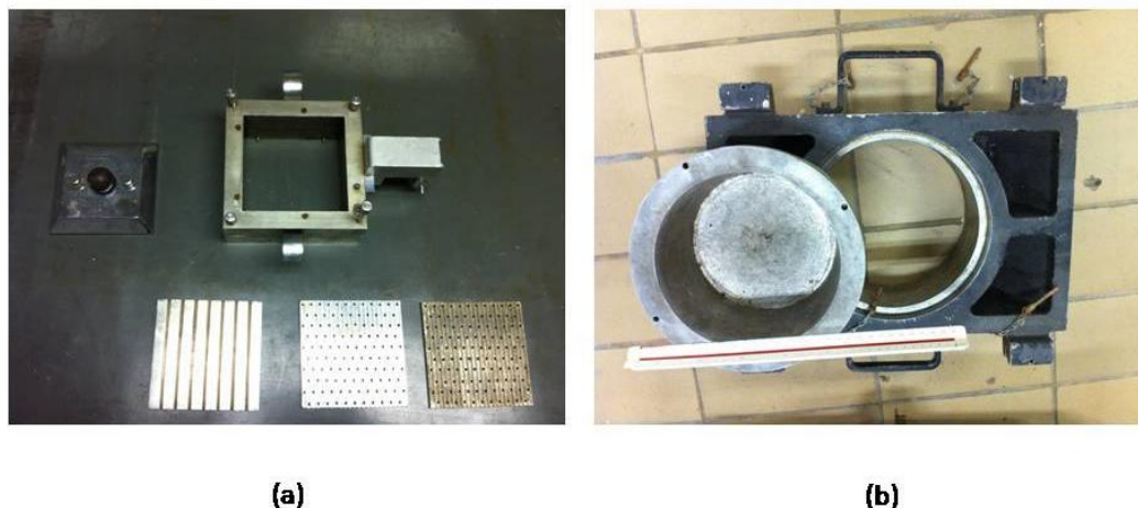
Figura 22 – Recipientes de material; (a) Caixa de cisalhamento do Lab. Fernando Manoel Barata; (b) Caixa de cisalhamento do LAMETRO.
