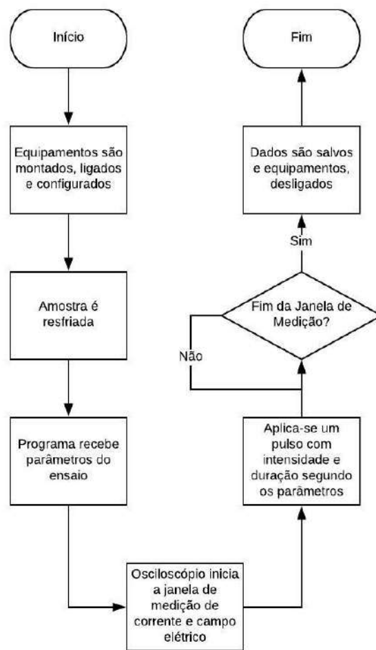
Figura 3.14: Ensaio de magnetização: Passo a passo
