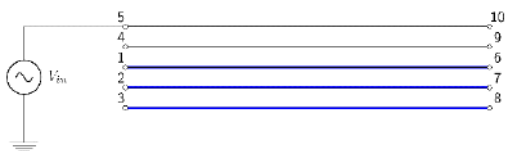
(a) Circuito para impulso em um dos cabos pararraios
