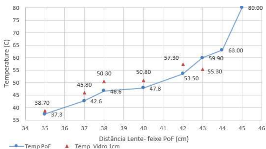
Figura 3.34 - Ensaios de temperatura em relação à distância lente Fresnel e feixe POF, vidro de espessura 1 cm.
