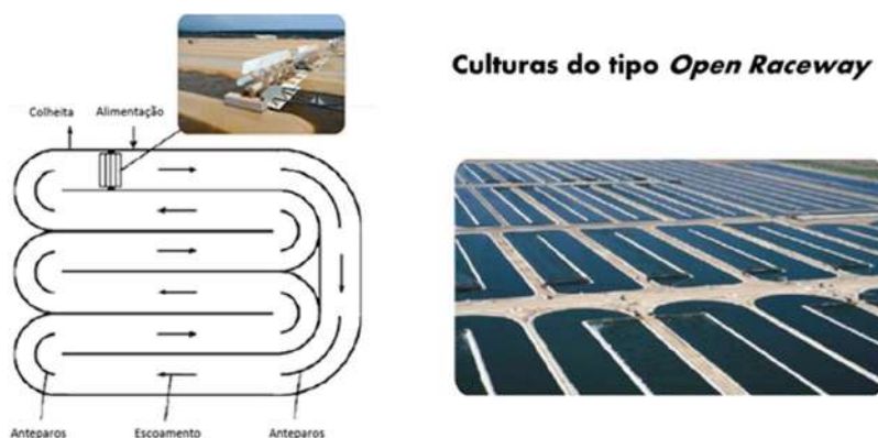
Figura 2.13 - Esquema do tanque aberto, adaptada [54].
