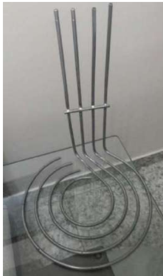
Figura 3.5 - Sistema de distribuição da aeração no Fotobiorreator de 30 litros.
