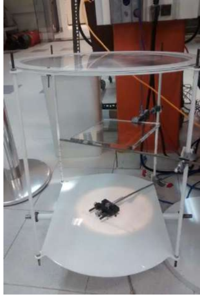
Figura 3.29 - Desenvolvimento do ensaio medição de temperatura com o uso de filtro de acrílico.
