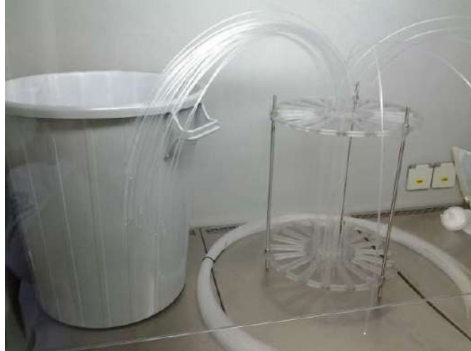
Figura 3.4 – fotografia do suporte com disco de acrílico para distribuição das POFs.
