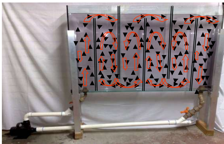
Figura 3.6 - Protótipo de PBR janela usado como referência comparativa com PBR de iluminação interna, adaptada de [66].
