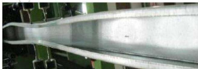
Figura 1.2 –Interação dos modos de flambagem local-distorcional-global em ensaios experimentais (SANTOS, 2014).
