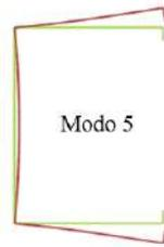
Figura 2.10 - Modo distorcional de deformação para análise de flambagem elástica via GBTUL (BEBIANO *et al.*, 2010).
