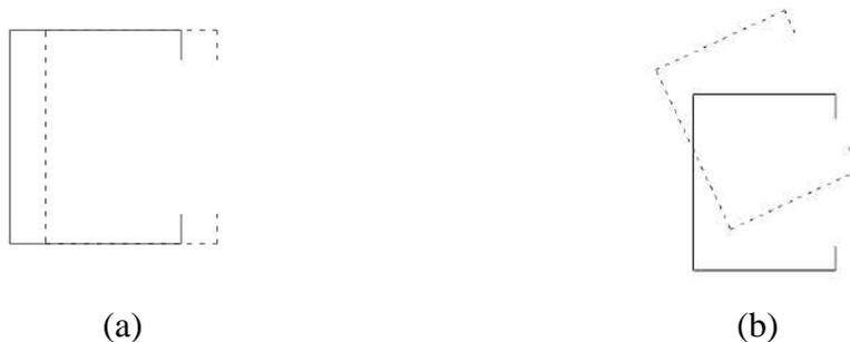
Figura 2.3 –Modos de flambagem global: (a) flexão na menor inércia (b) flexotorção.
