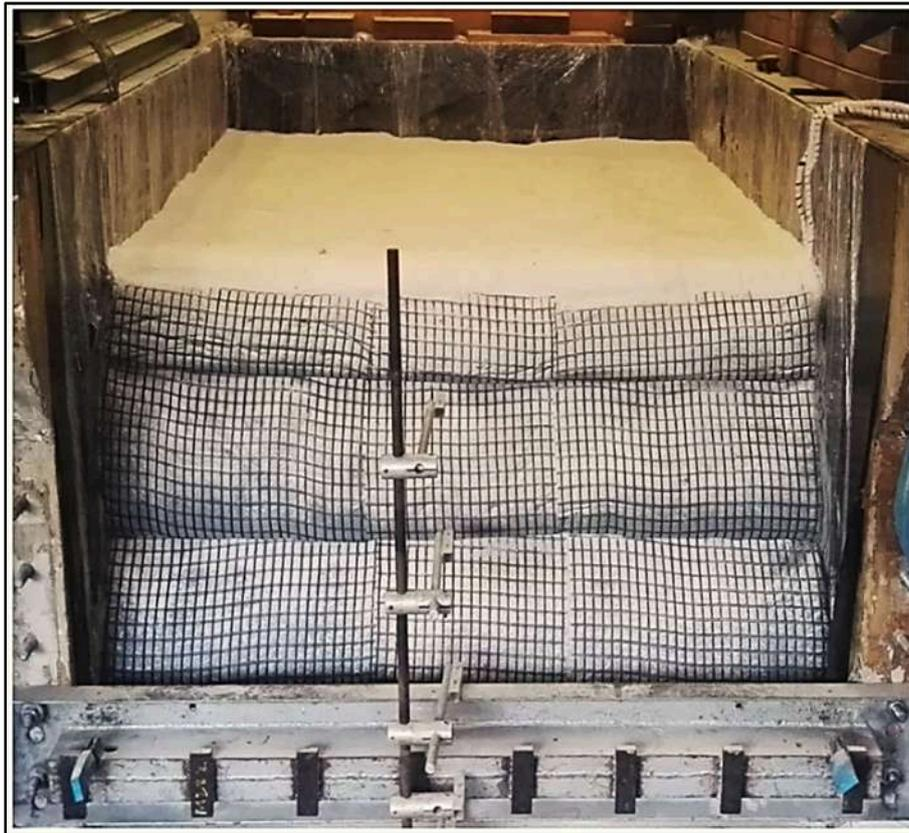
Figura 3.9. Vista frontal do muro com face envelopada após retirada da restrição lateral da face e base (condição final de construção e antes do carregamento).
