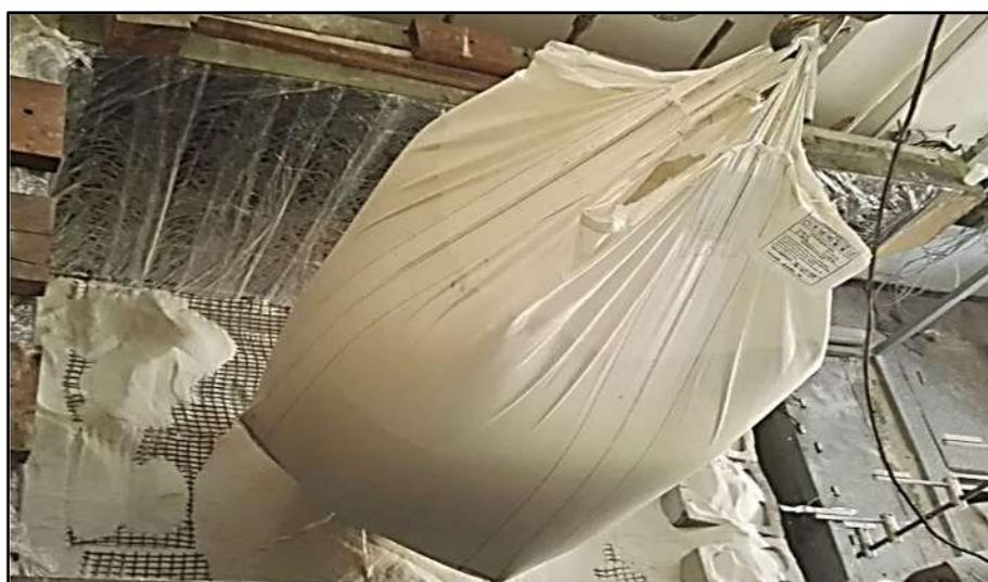
Figura 3.4. Lançamento de uma camada de solo dentro da caixa de concreto no caso de um muro com face de blocos.
