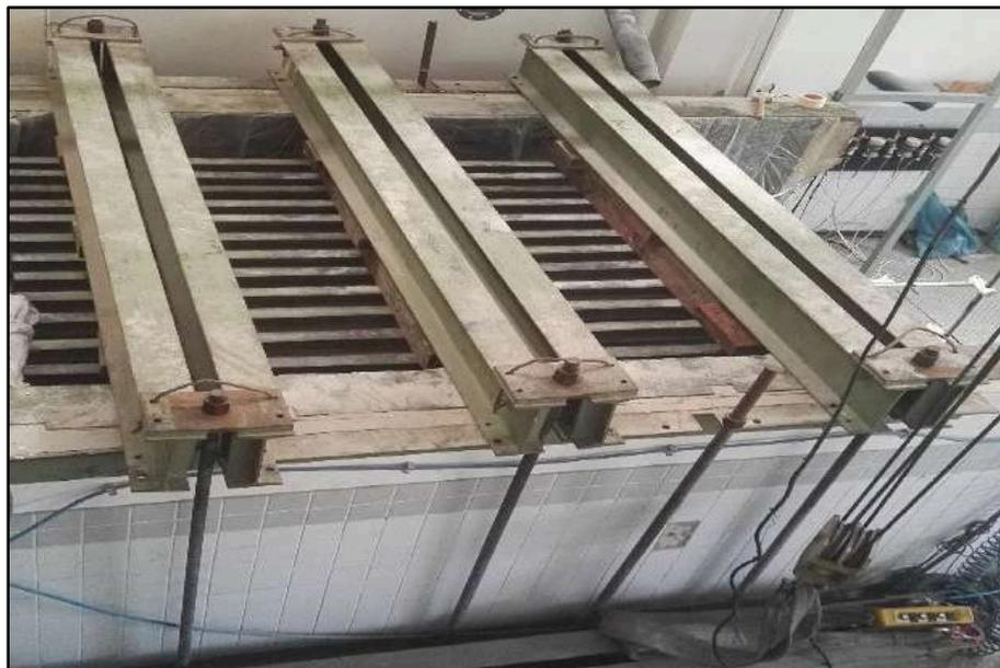
Figura 3.14. Sistema de reação para aplicação de sobrecarga.
