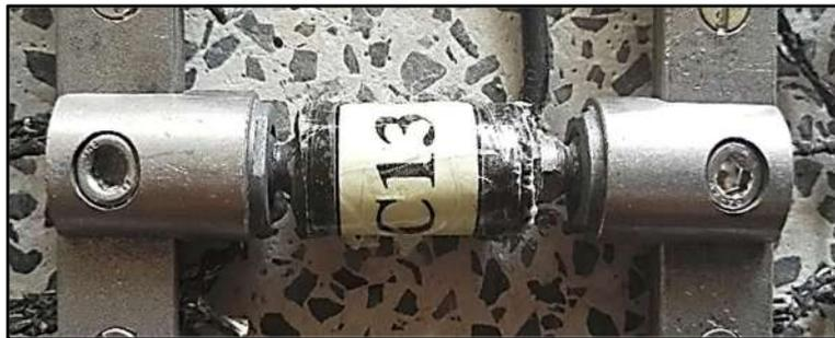
Figura 3.19. Célula de carga.
