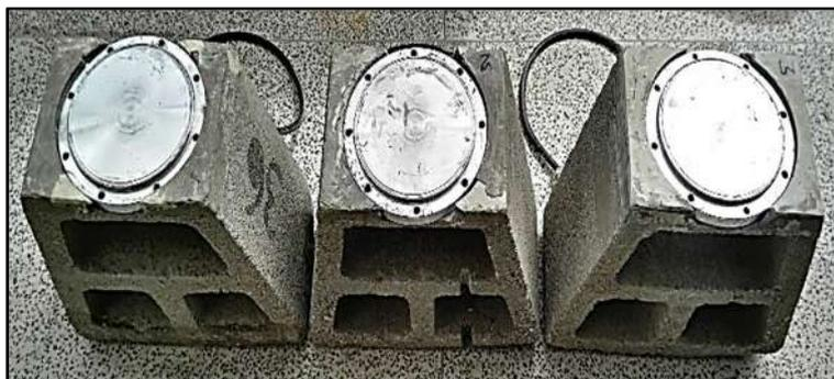
Figura 3.21. CTT instalado na face posterior dos blocos de concreto.
