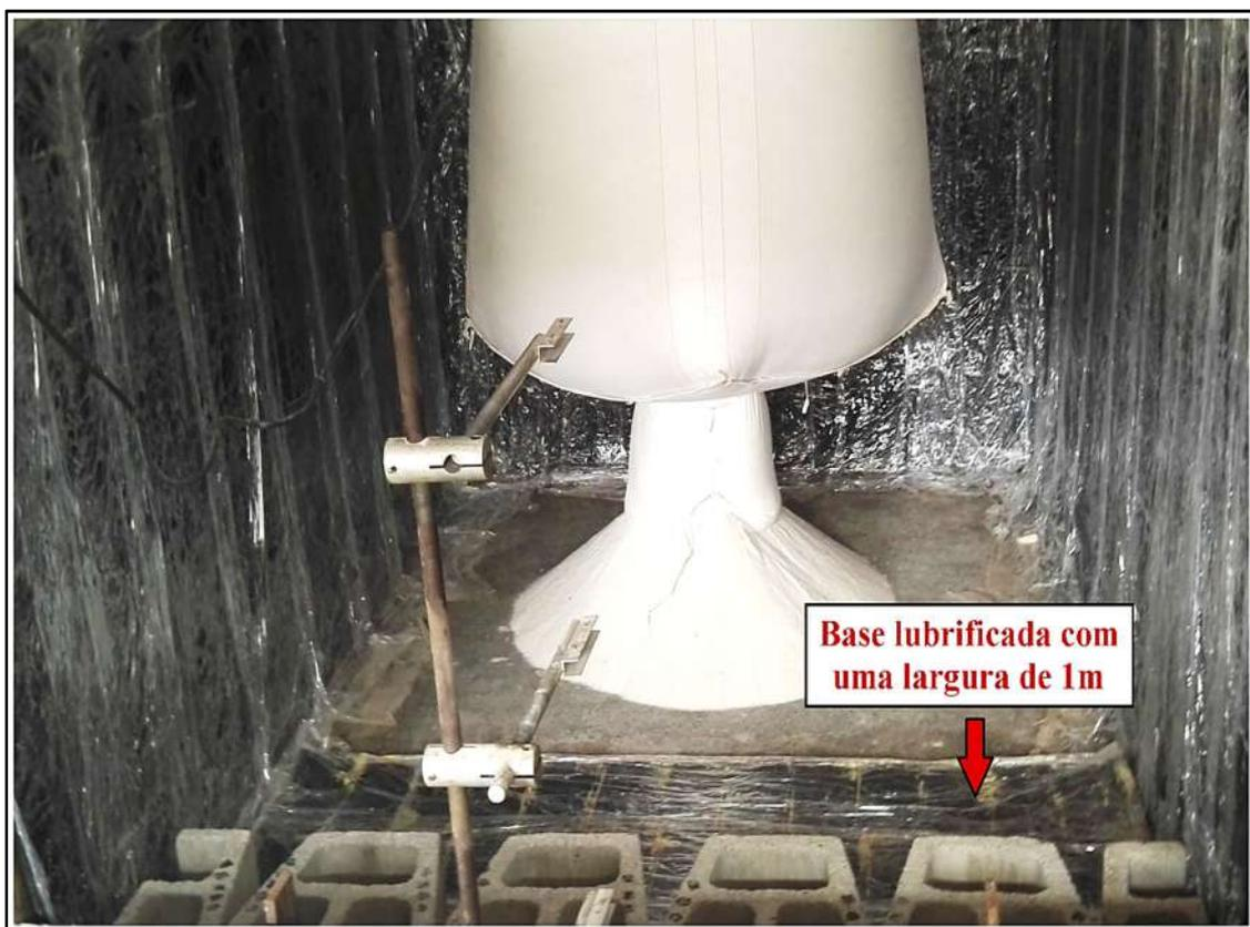
Figura 3.11. Lubrificação da base com sanduíche de borracha e graxa de teflon.
