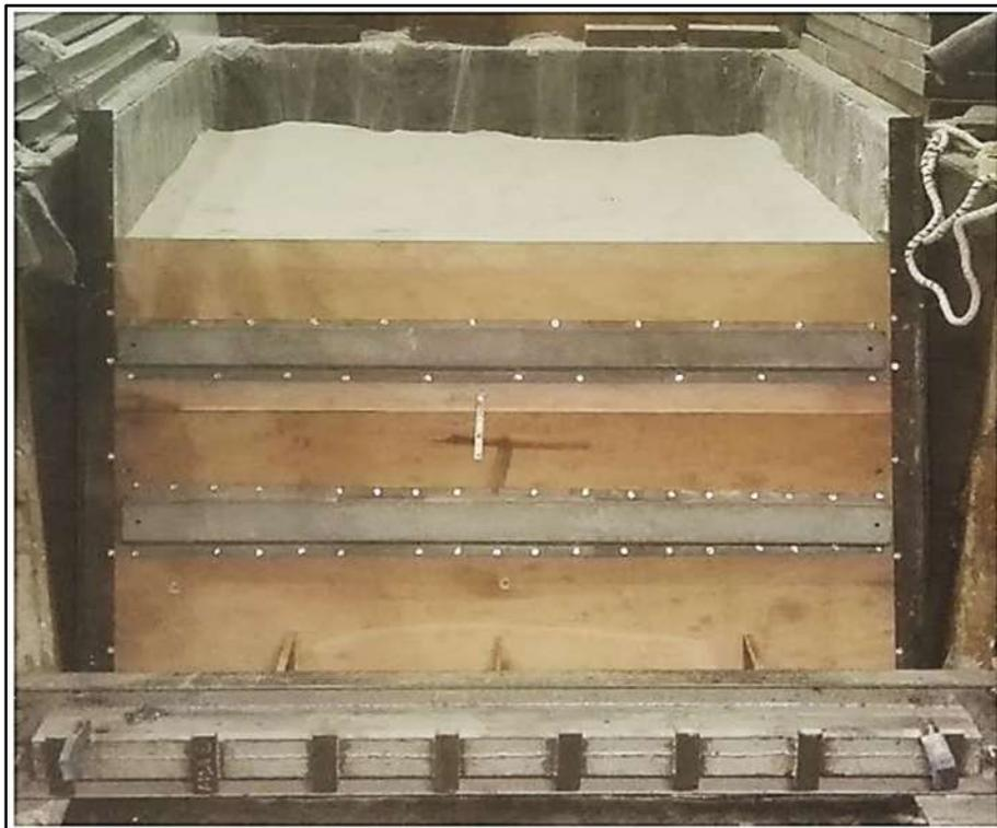
Figura 3.8. Vista frontal do muro com face envelopada antes da retirada da restrição lateral da face e base.
