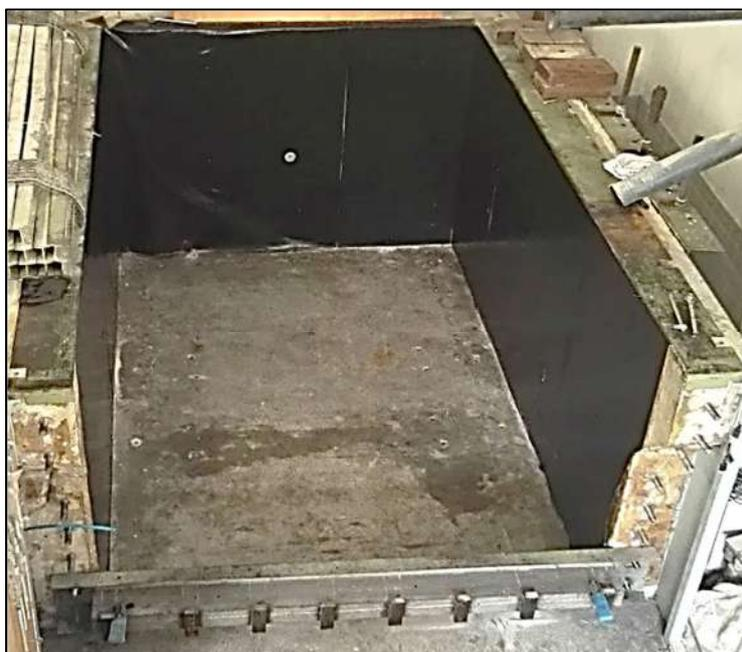
Figura 3.1. Caixa de concreto para ensaio de MSRГ no laboratório de Geotecnia da COPPE – UFRJ.
