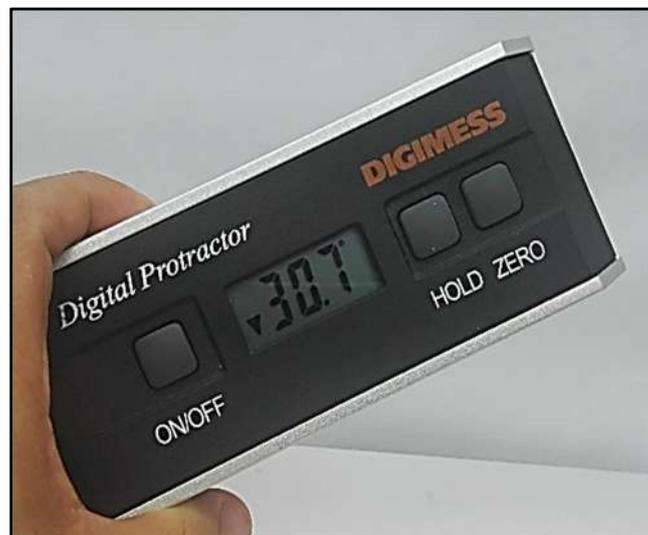
Figura 3.10. Medidor de inclinação digital.
