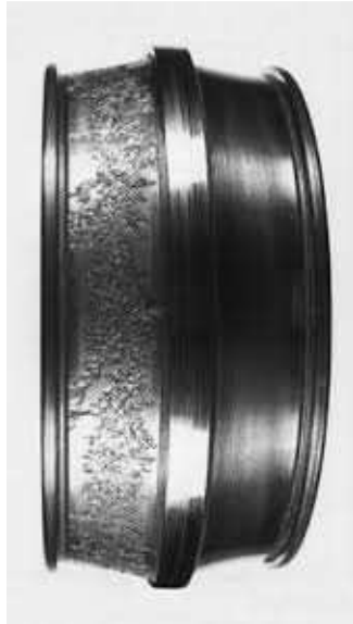
Figura 4 - Defeito pista interna proveniente do carregamento
