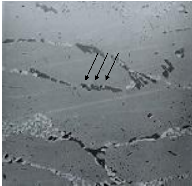
Figura 2.9 - Microestrutura do aço HP modificado ao nióbio com a presença de vazios de fluência [1].
