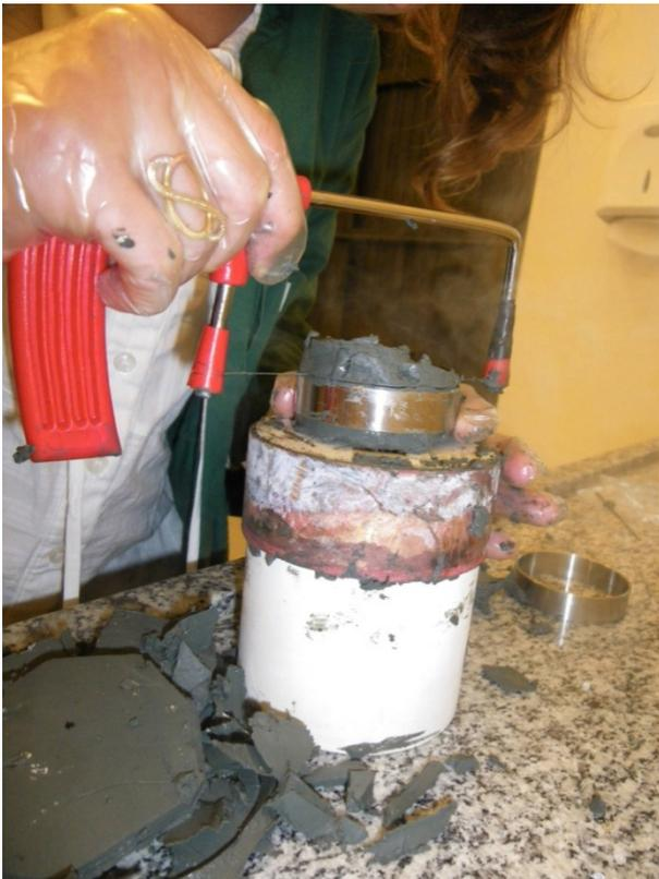
Figura 3.6 – Moldagem da amostra (Jannuzzi, 2013).
