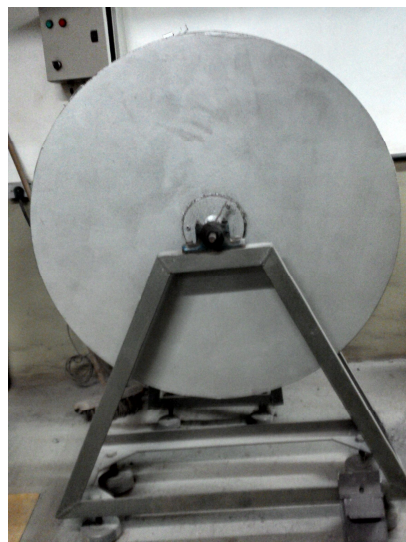
Figura 13 – Tambor utilizado no ensaio de tamboramento.
