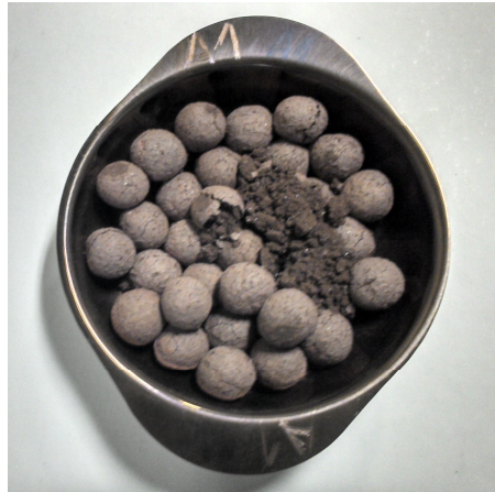
Figura 15 – Exemplo de um lote de pelotas que não foi utilizado nos ensaios de resistência devido à impossibilidade de manusear as pelotas.
