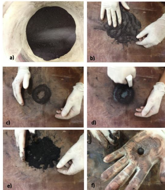
Figura 8 - Etapas do processo de confecção manual das pelotas. Retirada de [17].
