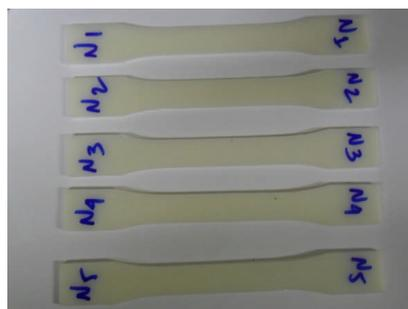
Figura 37: CPs fabricados e numerados
