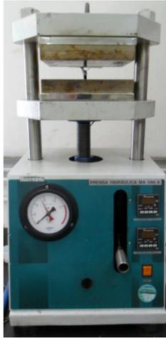
Figura 35: Prensa hidráulica 220°C
