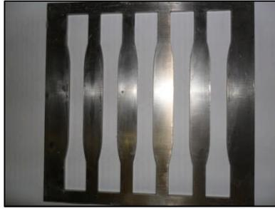
Figura 33: Molde para fabricação de cinco corpos de prova por batelada.
