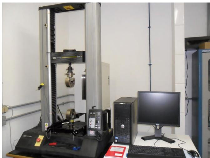
Figura 38: Máquina INSTRON 5567 com câmara térmica
