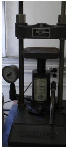
Figura 36: Prensa hidráulica 80°C
