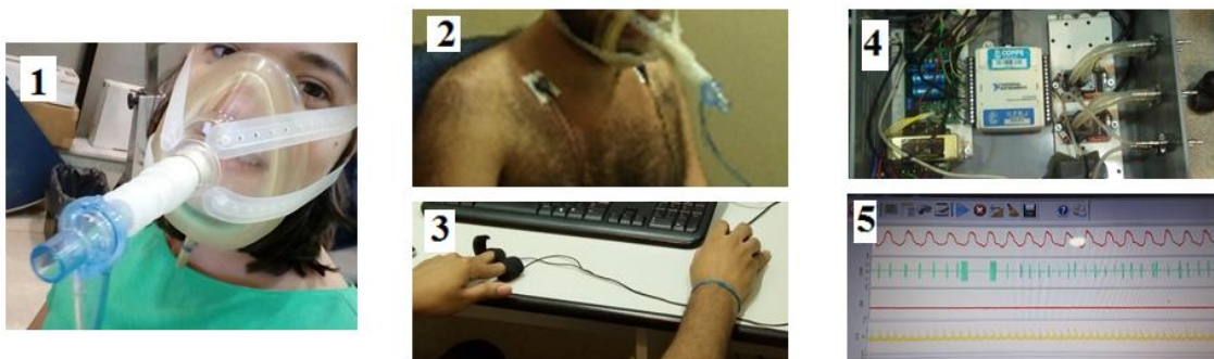
Figura 12: Fotos dos equipamentos: máscara e pneumotacógrafo (1); Eletrodos do ECG (2); Sensores de EDA e Biopac (3). Sinais adquiridos pela placa de aquisição conversora analógico digital (4) e programa de aquisição de dados Data Acquisition System (5).
