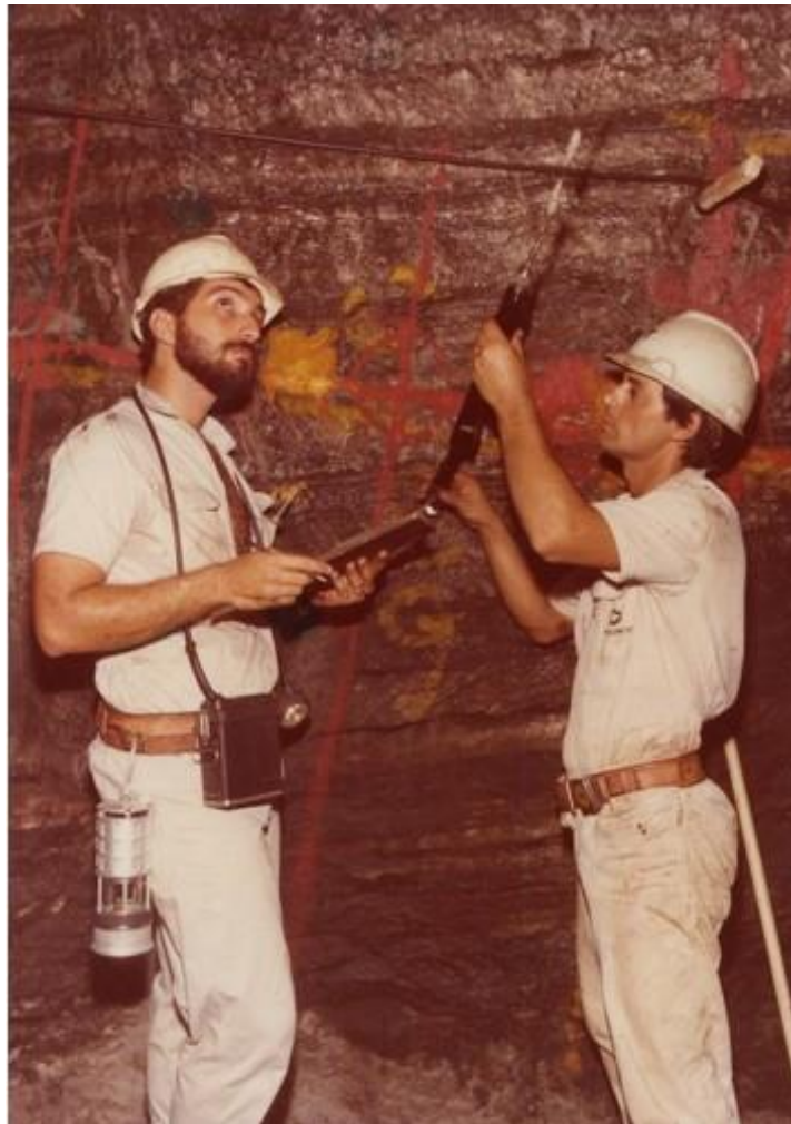
Figura 118. Medição de convergência realizada na galeria experimental C1D1
