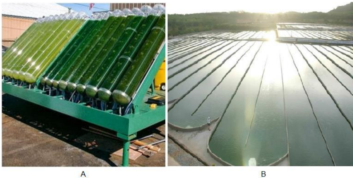
Figura 2 – Foto ilustrativa de sistemas de cultivo fechado e aberto. A) Fotobiorreatores do Centro de Pesquisa de microalgas na Embrapa de Brasília-DF e B) Lagoas de produção de Spirulina na província de Hainan, China.
