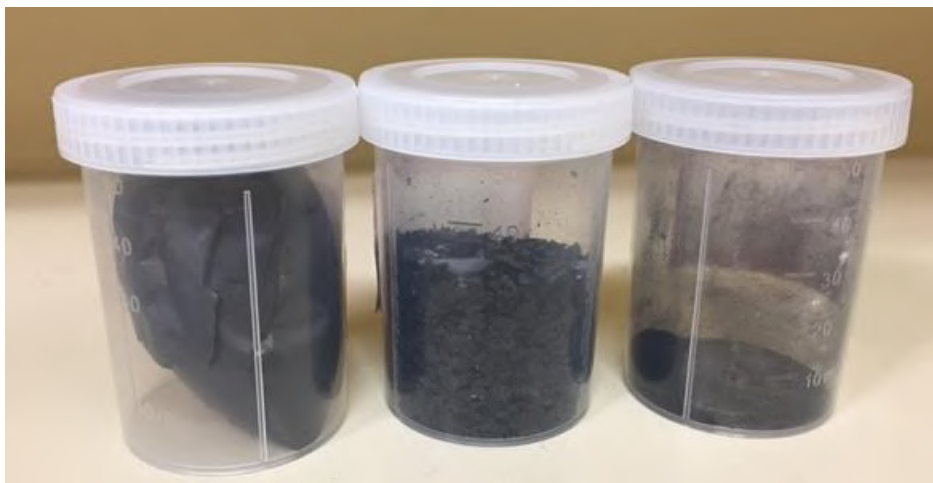
Figura 3.2 – Óxido de grafite (da esquerda para a direita): após secagem (filme), macerado no moinho de facas e macerado no moinho analítico (pó).
