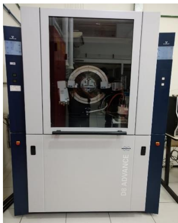
Figura 23: Equipamento D8 Advance – Modelo XRK900 da AntomParr
