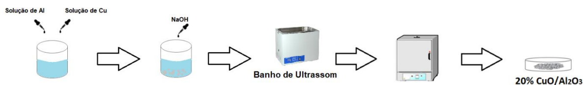
Figura 16: Esquema de preparação para amostra de co-precipitação.
