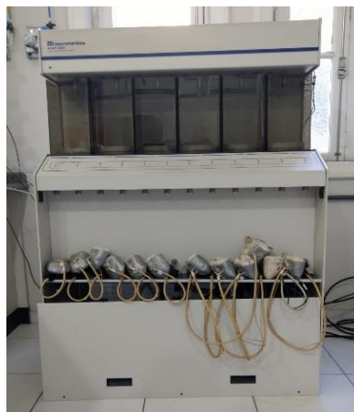
Figura 22: Equipamento ASAP 2420 da Micromeritics
