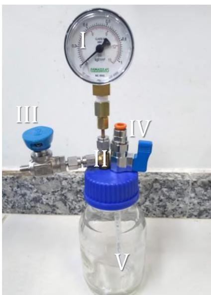
Figura 5.4: Biorreator finalizado. Em I - Manómetro, II - Conexão T. III - Válvula de gás. IV - Válvula de líquido. V - Extensão da saída de líquido em tubo de PEBD.
