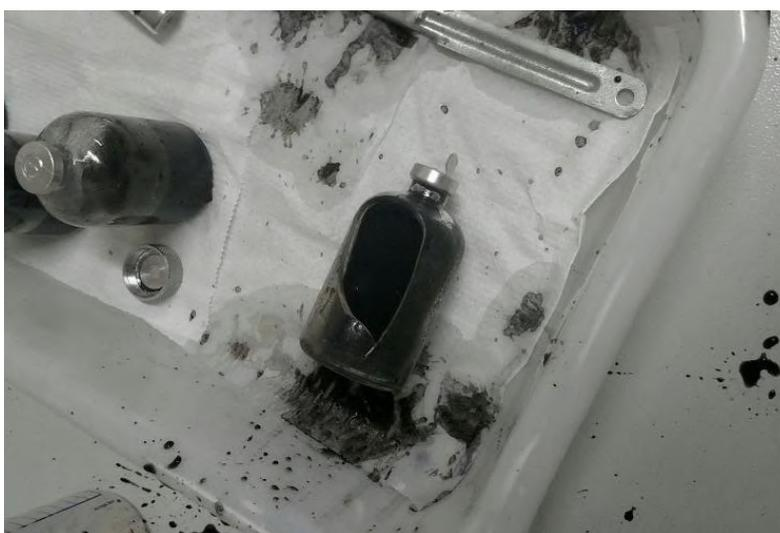
Figura 3.10: Registro do frasco penicilina quebrado ao final da fermentação. O acidente ocorreu dentro do Shaker e não houve feridos.
