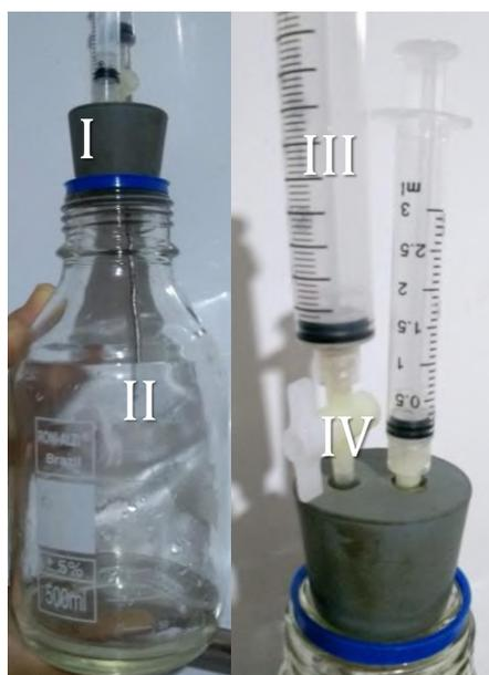
Figura 5.1: Primeiro protótipo de biorreator. I – Rolha de silicone. II - Extensão da saída de líquido, III - Seringas para coleta de líquido e gás. IV - Válvula de duas vias
