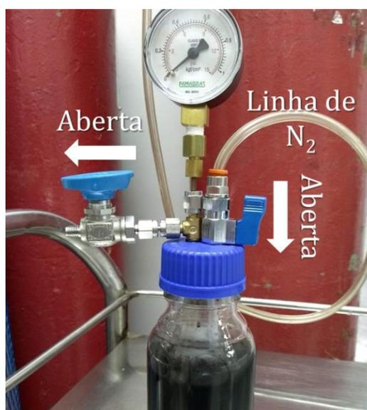
Figura 4.3: Purga do biorreator. Entrada de nitrogênio pela válvula à direita e a saída de gás pela válvula à esquerda.
