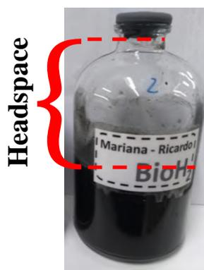
Figura 4.2: Foto de um frasco penicilina com a representação do volume de “headspace” destacada em vermelho
