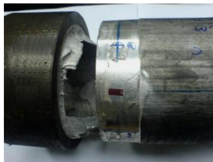
Figura 26 – Região de falha típica de amostras do grupo 2 [58]
