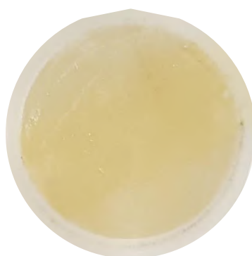
Figura 5.33 – Membrana de ultrafiltração após permeação de água pré-tratada em laboratório a partir de Ef_{\text{MBBR}} + \text{Água}_{\text{RIO}} .
