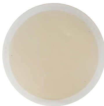
Figura 5.31 – Membrana após teste de determinação de SDI de água pré-tratada em laboratório a partir de Ef_{MBBR} + \text{Água}_{Rio} .
