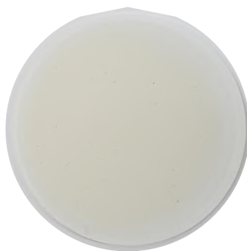
Figura 5.32 – Membrana do teste de determinação de SDI da água pré-tratada coletada após o filtro cartucho da ETA.
