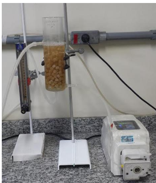
Figura 4.7 – Unidade experimental de tratamento biológico com MBBR.
