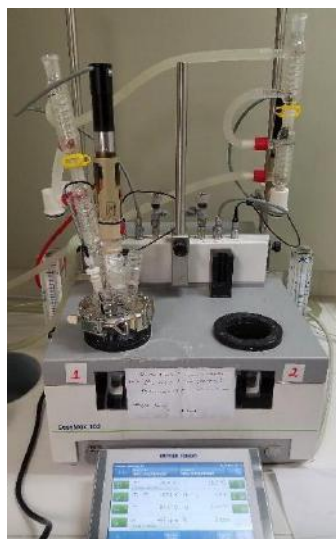
Figura IV - 2. Minirreator de polimerização utilizado nos ensaios, à esquerda. Esquemática do conjunto de controles utilizados, à direita.
