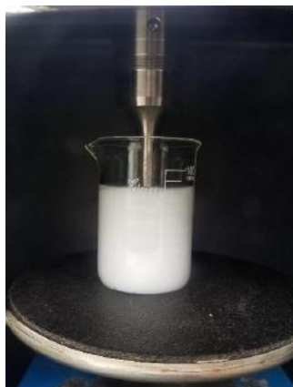
Figura IV - 1. Sistema de sonicação utilizado.
