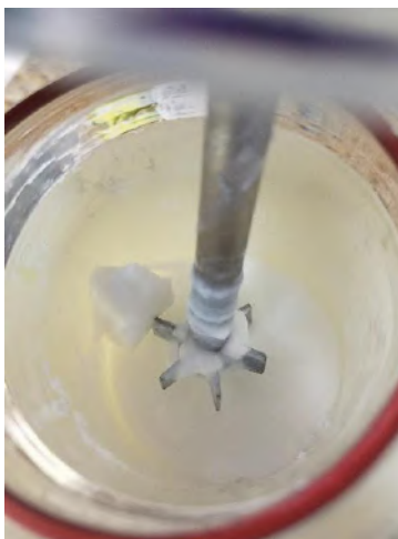
Figura V - 2. Detalhe da aglomeração formada na reação de copolimerização P(MMA-co-AA)15%.
