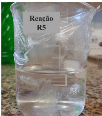
Figura 4. 4. Teste de solubilidade qualitativo das partículas de gelatina obtidas da reação R5 (5 horas) na presença de formaldeído.
