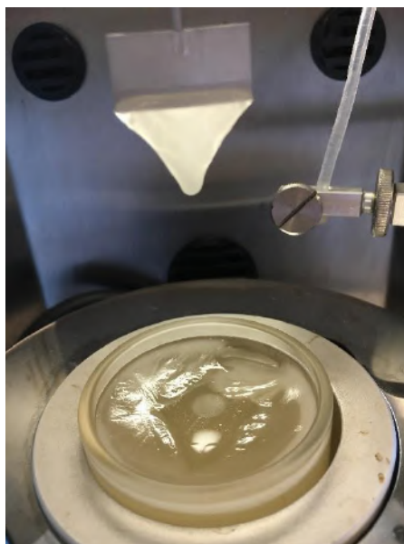
Figura 4. 69. Formação de filme em soluções de gelatina preparadas com óleo de manjeriço comercial durante ensaios de tensão superficial.
