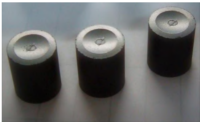
Figura 41: Amostras de pastilhas cerâmicas combustíveis de UO_2 sinterizadas (altura e diâmetro aproximadamente iguais a 11,20 e 9,30 mm, respectivamente).
