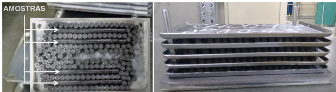
Figura 39: Ilustração do posicionamento das amostras em bandeja (esquerda) e a nave de produção montada (direita).
