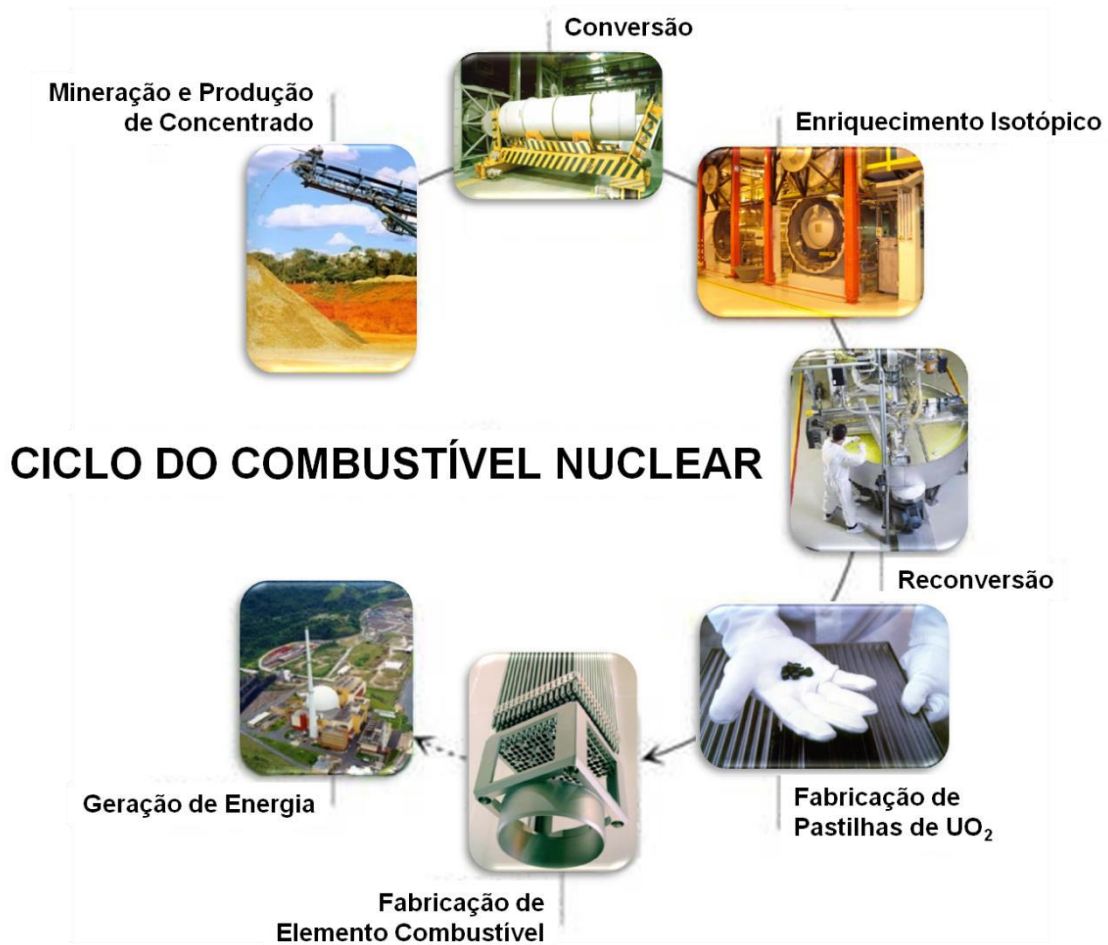
Figura 2: Fluxo produtivo das etapas do Ciclo do Combustível Nuclear. Adaptado de [7].
